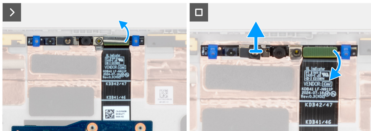
Afbeelding 77. De MIPI-camera verwijderen
