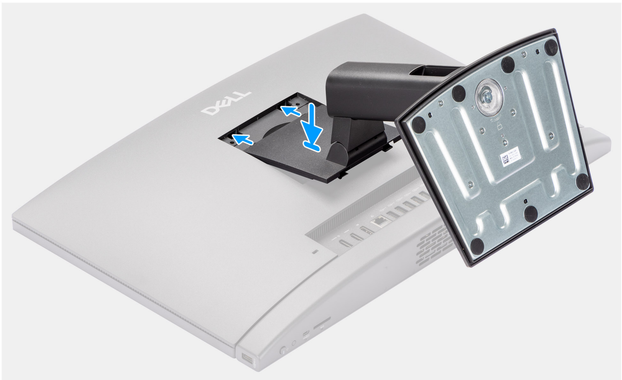
Ilustración 16. Instalación de la base fija
