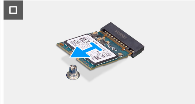
Ilustración 28. Extracción de la unidad de estado sólido M.2 2230 de la ranura M.2 1
