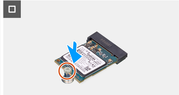
Ilustración 29. Instalación de la unidad de estado sólido M.2 2230 en la ranura M.2 1
