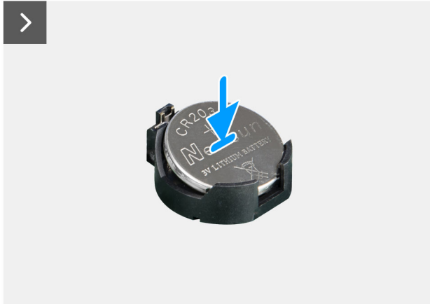
Ilustración 32. Instalación de la batería de tipo botón
