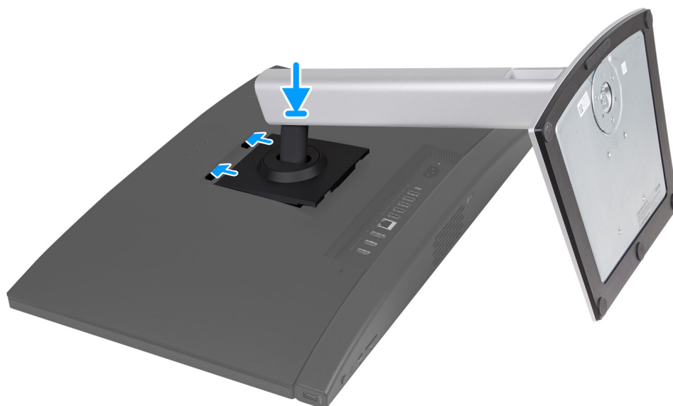
Ilustración 9. Instalación de la base
