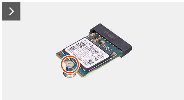
Ilustración 25. Extracción de la unidad de estado sólido M.2 2230 de la ranura M.2 0
