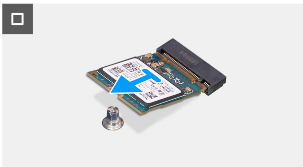
Ilustración 25. Extracción de la unidad de estado sólido M.2 2230 de la ranura M.2 0
