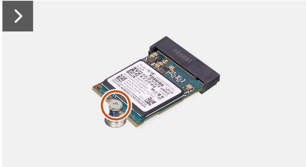
Ilustración 28. Extracción de la unidad de estado sólido M.2 2230 de la ranura M.2 1
