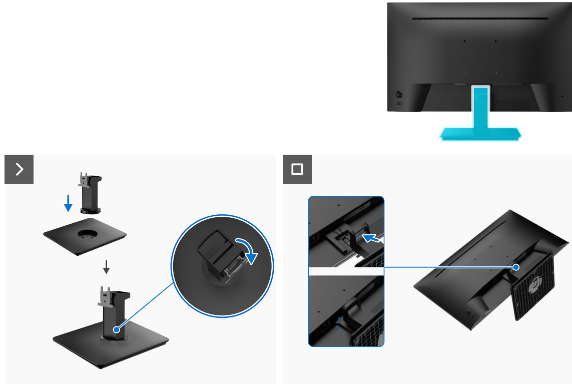
Figura 13. Instalar el pedestal
