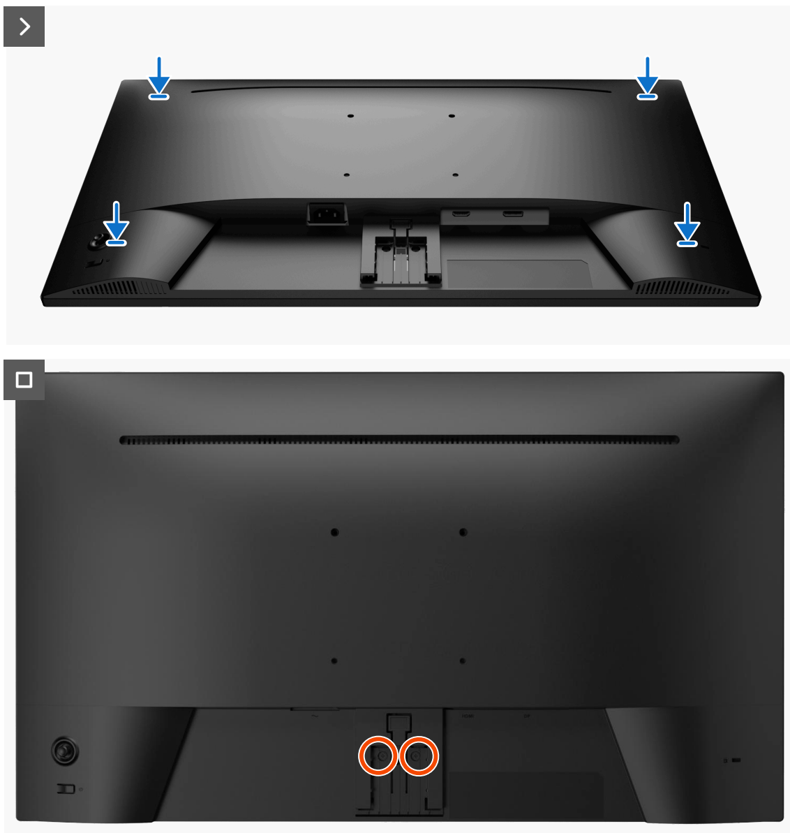
Figura 17. Instalar la cubierta posterior
