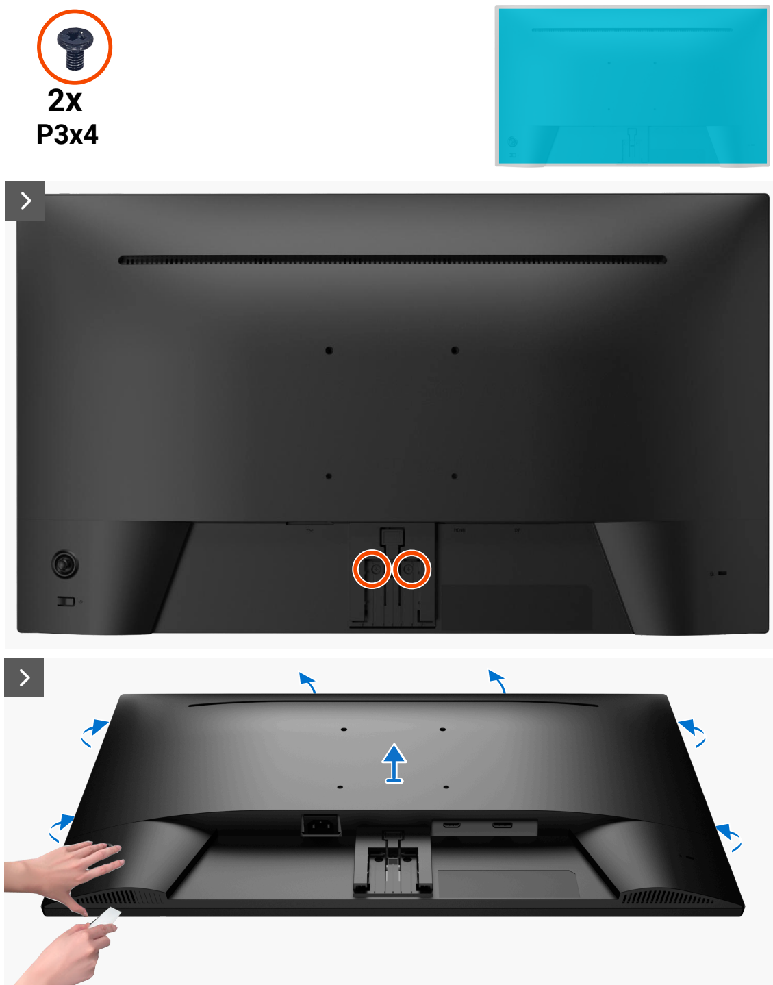
Figura 14. Retirar la cubierta posterior
