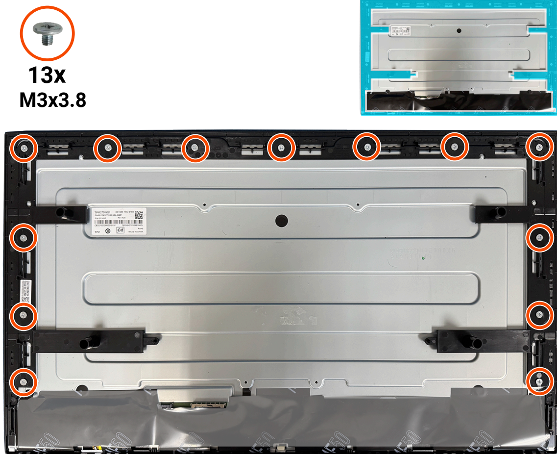
Figura 29. Instalar el marco central
