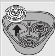
**4** Izvadite rezače i štitnike i očistite ih isporučenom četkicom.
