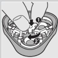
**5** Vratite okvir za pričvršćivanje u jedinicu za brijanje (1) i okrenite kotačić u smjeru kazaljke na satu (2).
