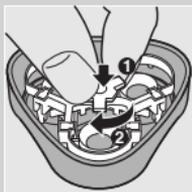
**7** Vratite glave za brijanje u jedinicu za brijanje. Vratite granični okvir u jedinicu za brijanje (1) i okrenite točkić u smeru kazaljke na satu (2).
