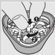
**7** Holiace hlavy vložte späť do holiacej jednotky. Prítlačný rám vložte späť do holiacej jednotky (1) a kolieskom otočte v smere pohybu hodinových ručičiek (2).
