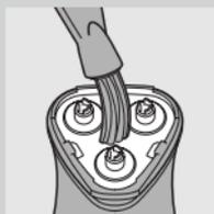
**4** Četkicom očistite unutrašnjost jedinice za brijanje i spremište za dlake.
