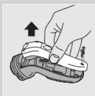
**2** Lăsați aparatul să funcționeze până când se oprește, desfaceți șuruburile și deschideți-l.
