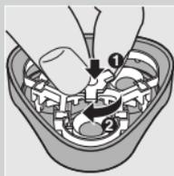
**5** Następnie załóż element zabezpieczający na element golący (1) i obróć blokadę w prawo (2).
