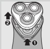
**3** Pritisnite gumb za otpuštanje (1) i izvadite jedinicu za brijanje (2).
