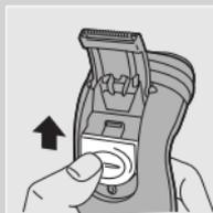
**1** Zastříhovač otevřete posunutím jeho spínače směrem nahoru.
