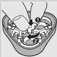
**7** Vložte holicí hlavy zpět do holicí jednotky. Umístěte přídržný rámeček zpět do holicí jednotky (1) a otočte kolečkem ve směru hodinových ručiček (2).
