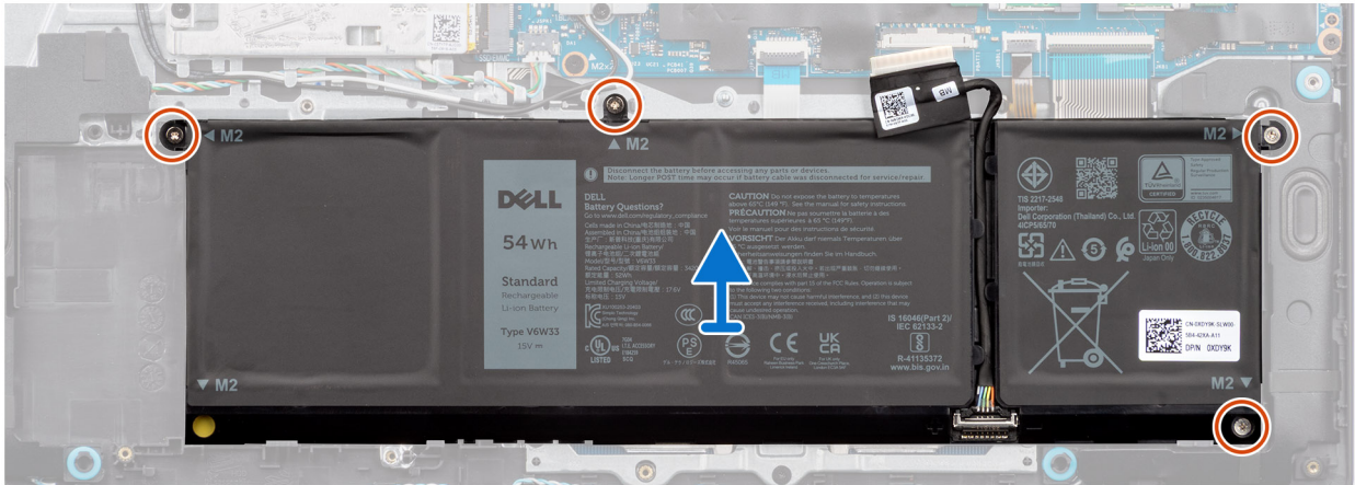
Ilustración 10. Extracción de la batería de 4 celdas
