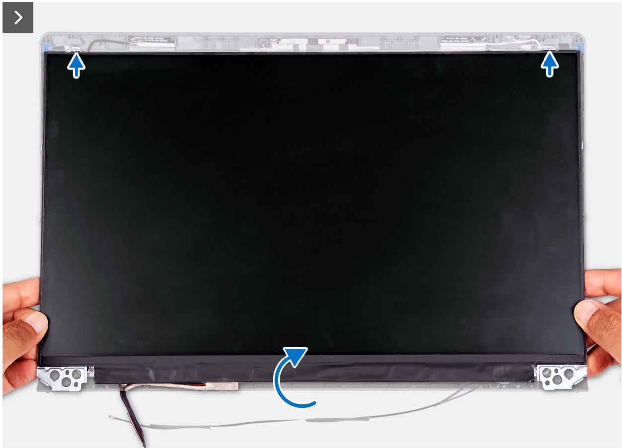
Ilustración 56. Instalación del panel de pantalla
