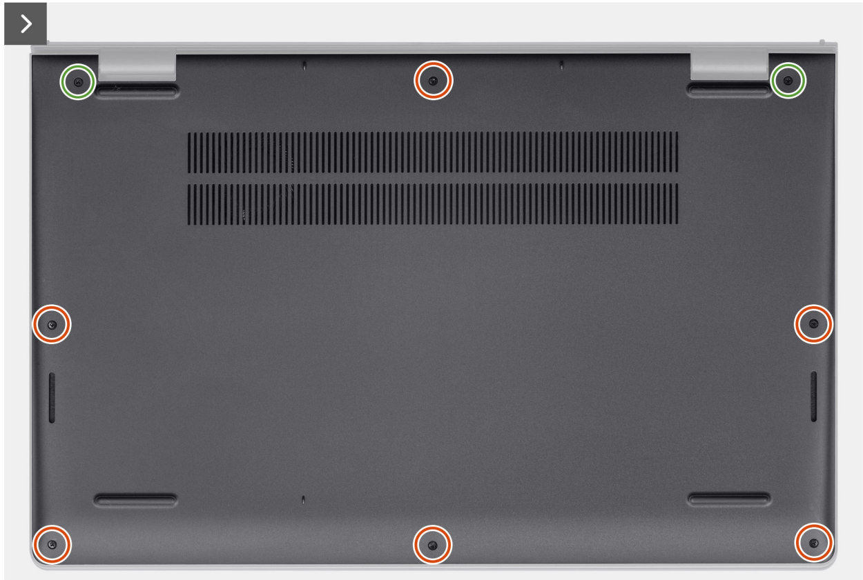
Ilustración 2. Extracción de la cubierta de la base
