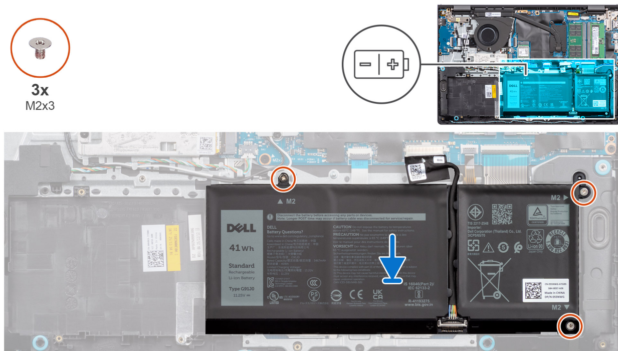
Ilustración 9. Instalación de la batería de 3 celdas
