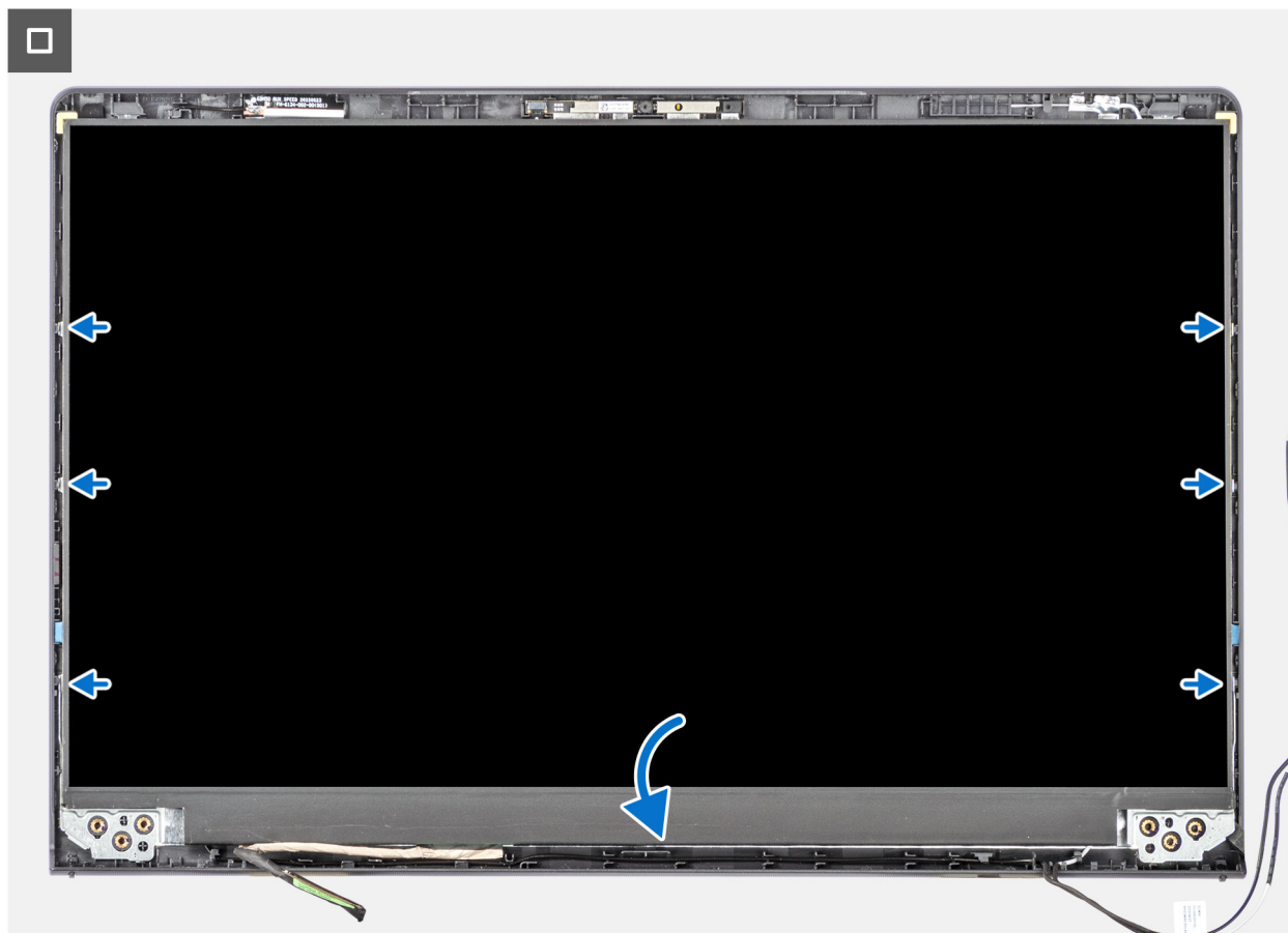
Ilustración 57. Instalación del panel de pantalla
