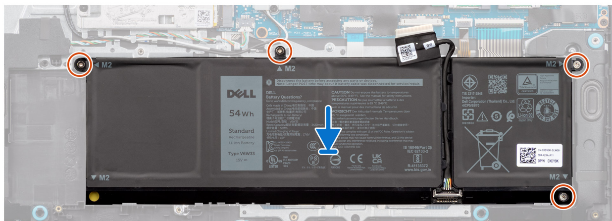
Ilustración 11. Instalación de la batería de 4 celdas
