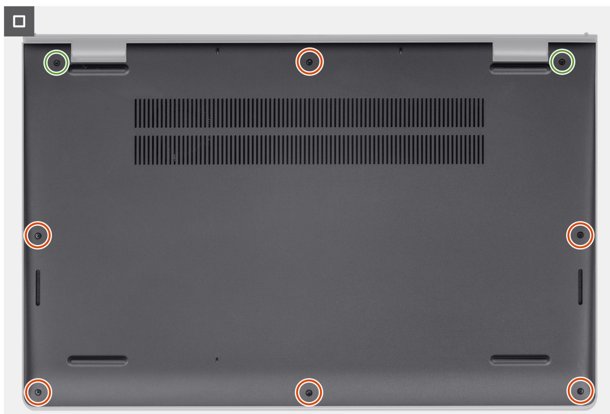
Ilustración 7. Instalación de la cubierta de la base
