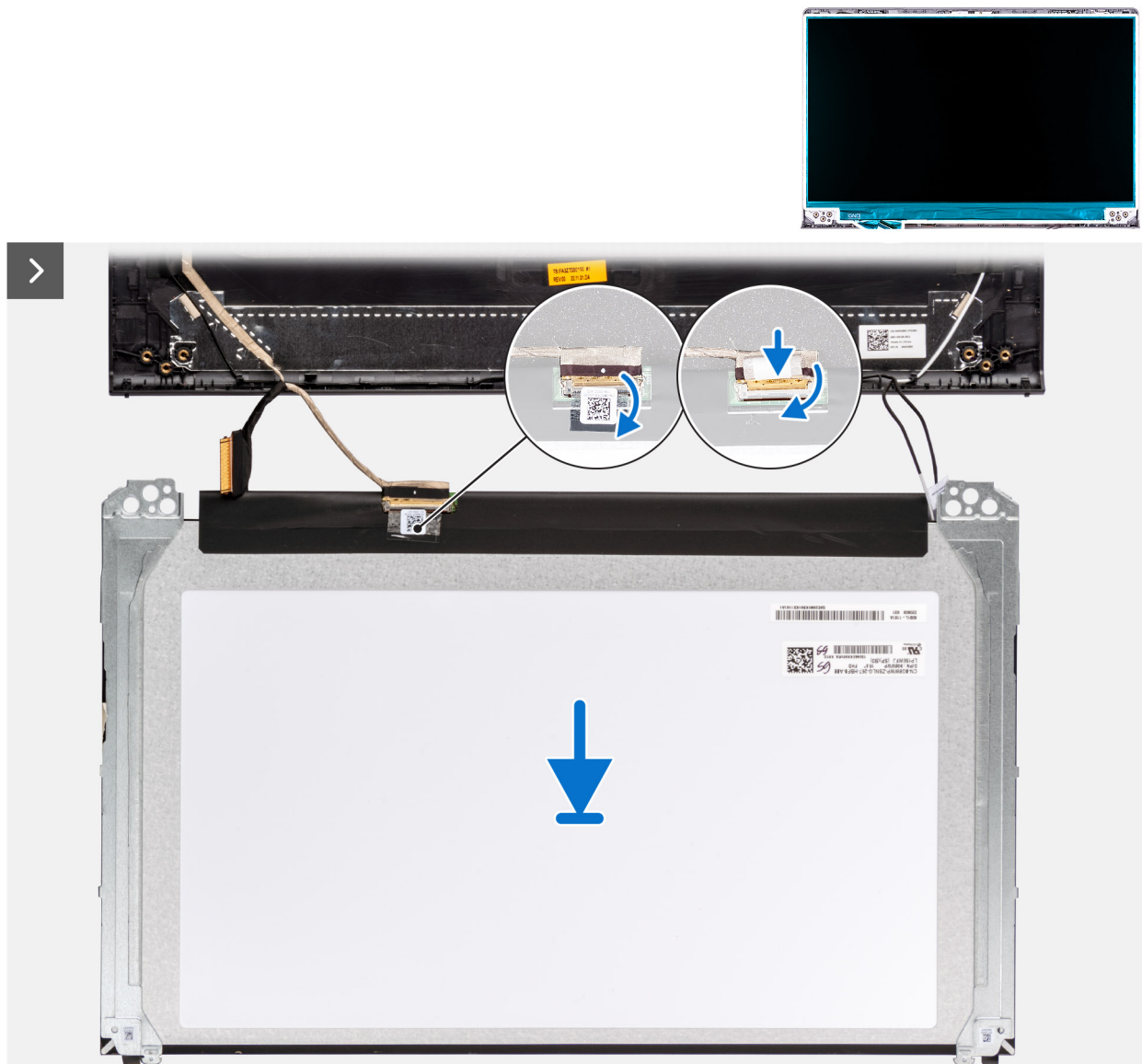
Ilustración 55. Instalación del panel de pantalla
