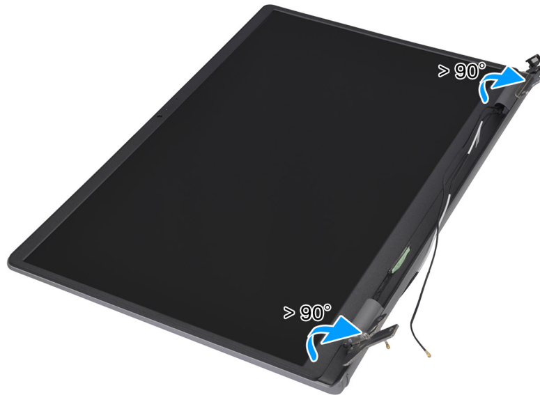
Ilustración 39. Apertura de las bisagras de la pantalla al menos a 90 grados
