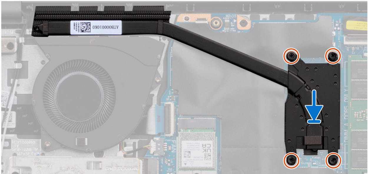
Ilustración 25. Instalación del disipador de calor
