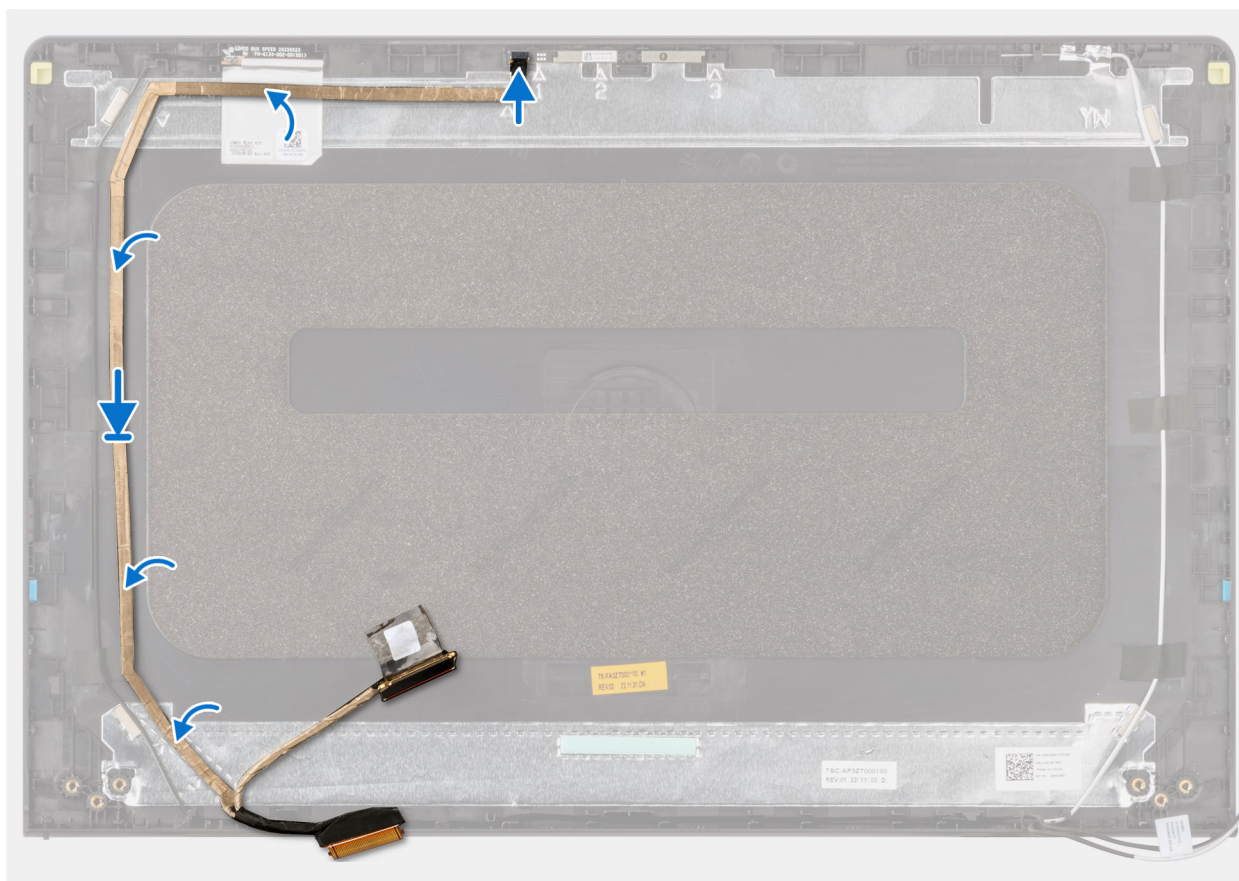
Ilustración 61. Instalación del cable de pantalla
