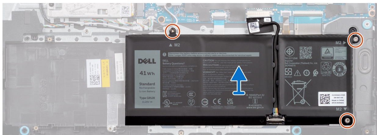
Ilustración 8. Extracción de la batería de 3 celdas
