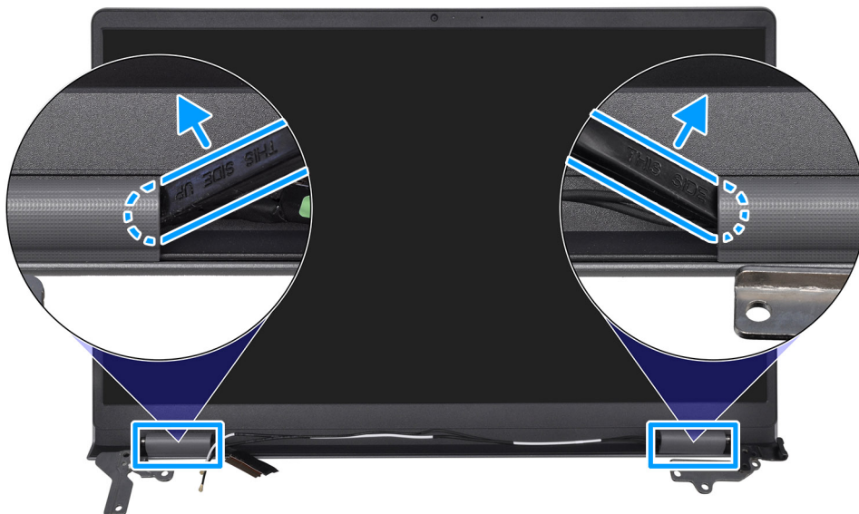
Ilustración 40. Cómo hacer palanca en las bisagras de la pantalla
