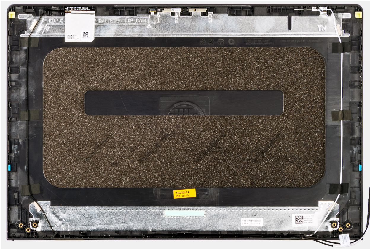
Ilustración 63. Instalación del ensamblaje de la antena y la cubierta posterior de la pantalla
