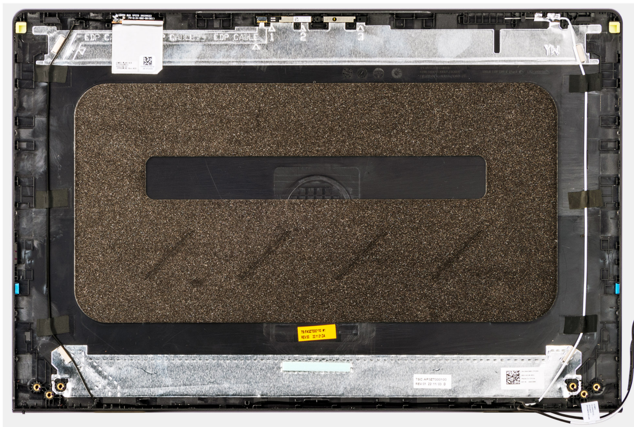
Ilustración 62. Extracción del ensamblaje de la antena y la cubierta posterior de la pantalla
