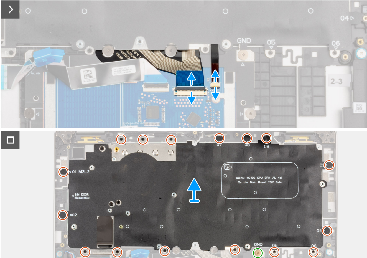
Figure 68. Retrait du clavier
