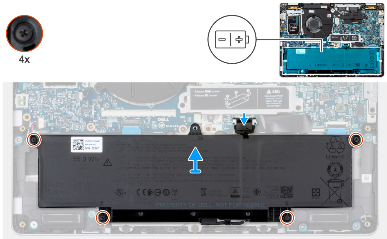
Figure 20. Installation de la batterie
