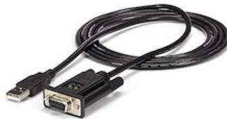
Das FTDI USB-auf-Nullmodem-Serielle-Adapterkabel (1 Port) ICUSB232FTN konvertiert einen verfügbaren USB 1.1 oder 2.0-Port in einen RS232-Nullmodem-Seriellen-DB9-Port, sodass DCE/DTE-Konflikte direkt gelöst werden, ohne dass zusätzliche kreuzverdrahtete serielle Kabel oder Adapter erforderlich sind.
