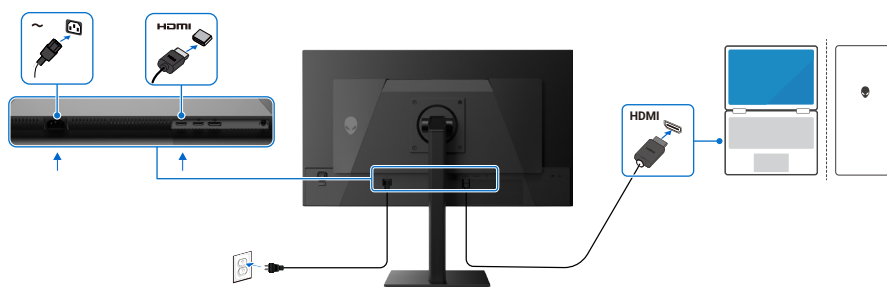
Figure 9. Branchement du câble HDMI
