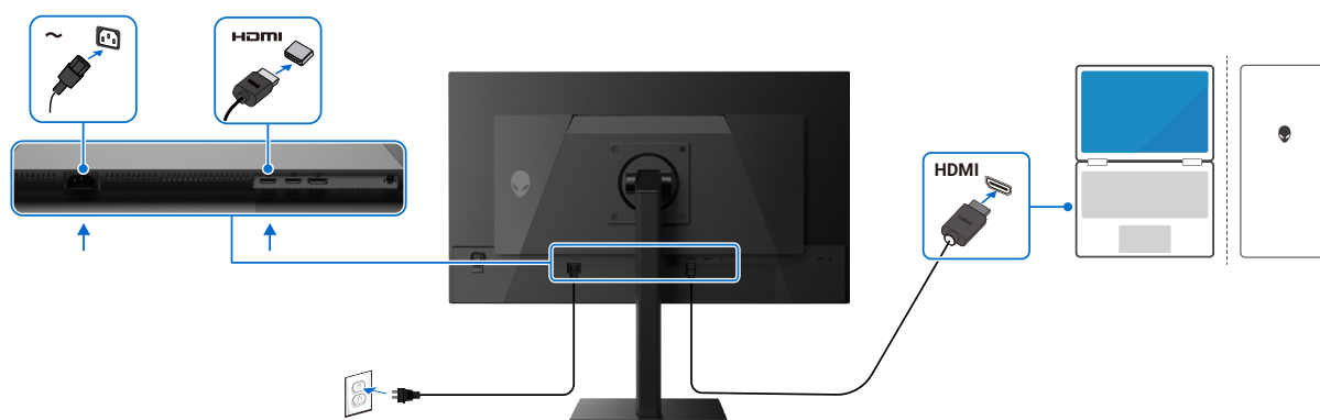
Figure 21. Branchement du câble HDMI
