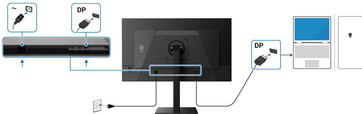
Afbeelding 20. De DisplayPort (DP naar DP)-kabel aansluiten
