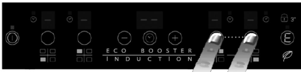
Per cambiare il livello di potenza, premere i tasti - / + (dal livello 1 fino al livello 9 o P max). Per disattivare la funzione Flexicook, premere simultaneamente i due tasti di selezione delle zone. Per disattivare immediatamente le zone di cottura, tenere premuto per 3 secondi il tasto di selezione della zona.
