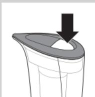
**Примітка:** Противапняний картридж має бути зафіковано в резервуарі для фільтрації належним чином.
