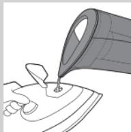
**2** Zbiralnik za vodo parnega ali sistemskega likalnika napolnite s filtrirano vodo.
