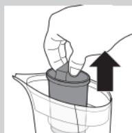
**2** Для извлечения старого картриджа от накипи из резервуара для фильтрации возмитесь за ручку картриджа.
