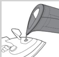
**2** Uzpildiet tvaika gludekļa vai tvaika ģeneratora ūdens tvertni ar filtrētu ūdeni.
