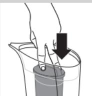
**4** Do filtračného zásobníka vložte novú kazetu proti tvorbe vodného kameňa.
