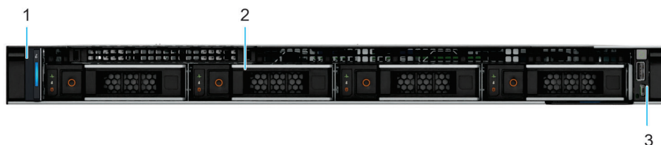
Figure 1. Vue avant d'un système de 4 disques de 3,5 pouces
