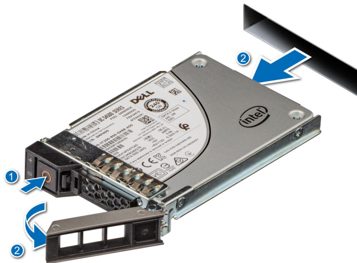
Figure 36. Retrait d'un support de disque
