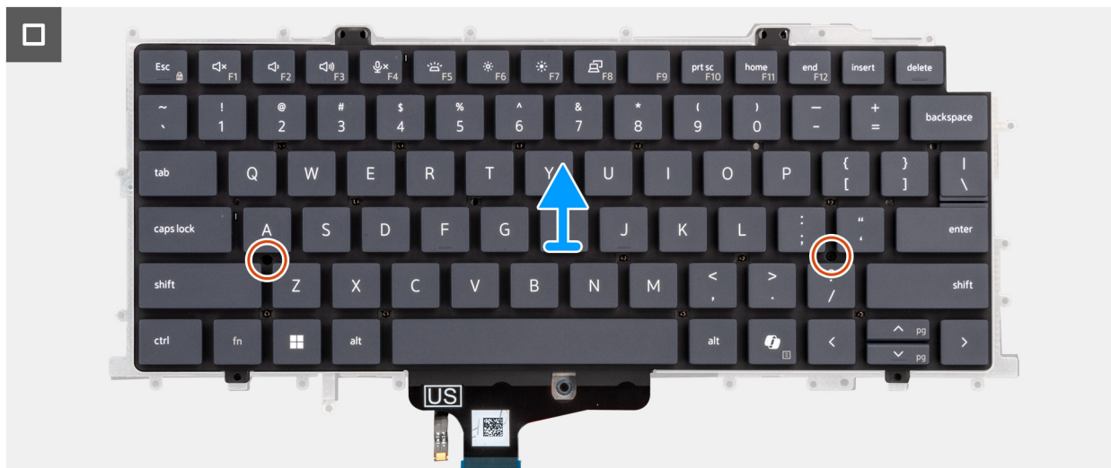
Afbeelding 82. Het toetsenbord verwijderen
