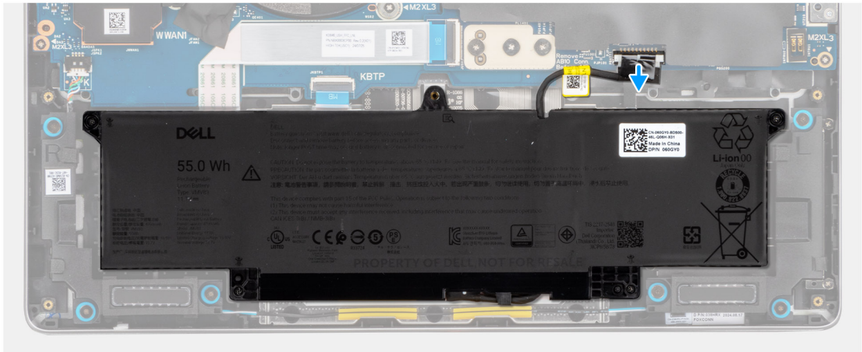
Afbeelding 24. De batterijkabel loskoppelen
