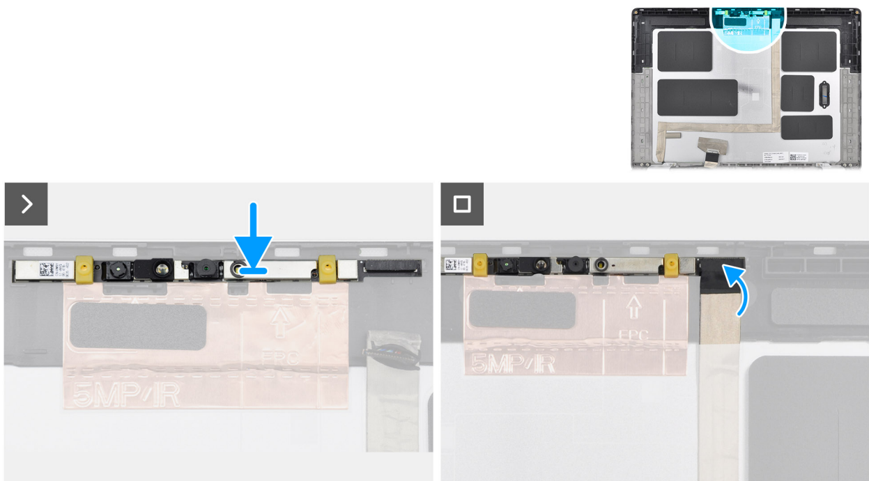
Afbeelding 76. De RGB/IR-camera installeren
