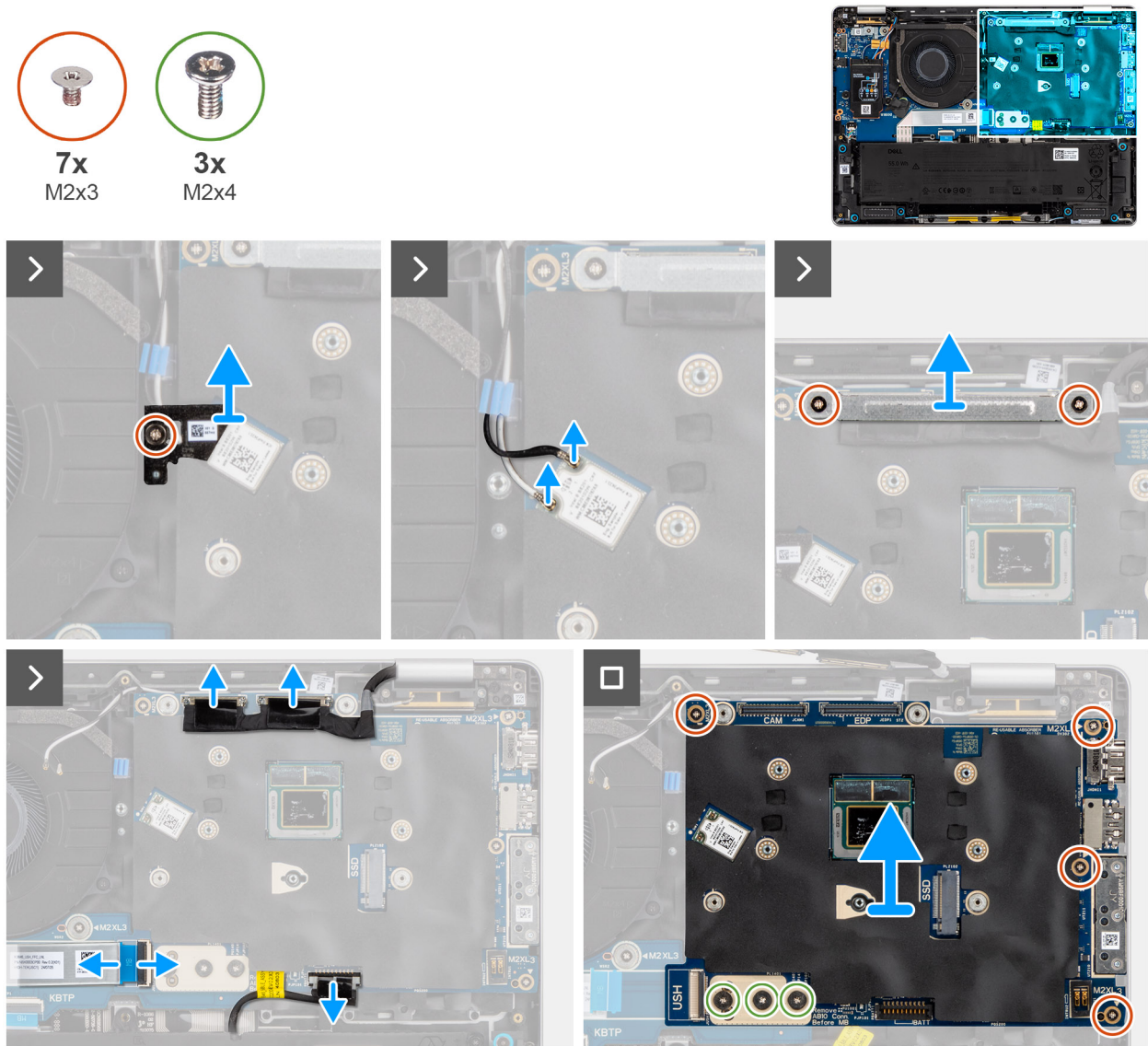
Afbeelding 48. De systeemkaart verwijderen
