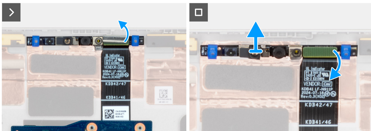
Afbeelding 77. De MIPI-camera verwijderen
