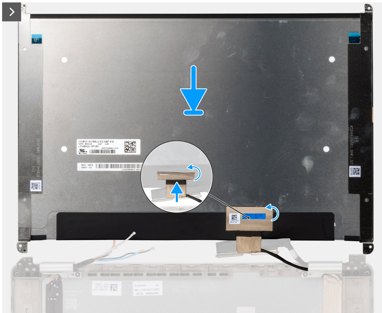
Afbeelding 71. Het beeldschermpaneel installeren
