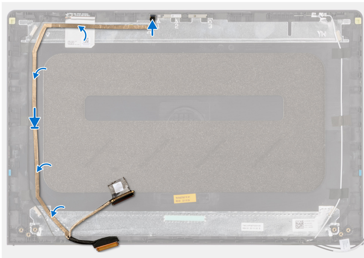
Afbeelding 61. De beeldschermkabel installeren
