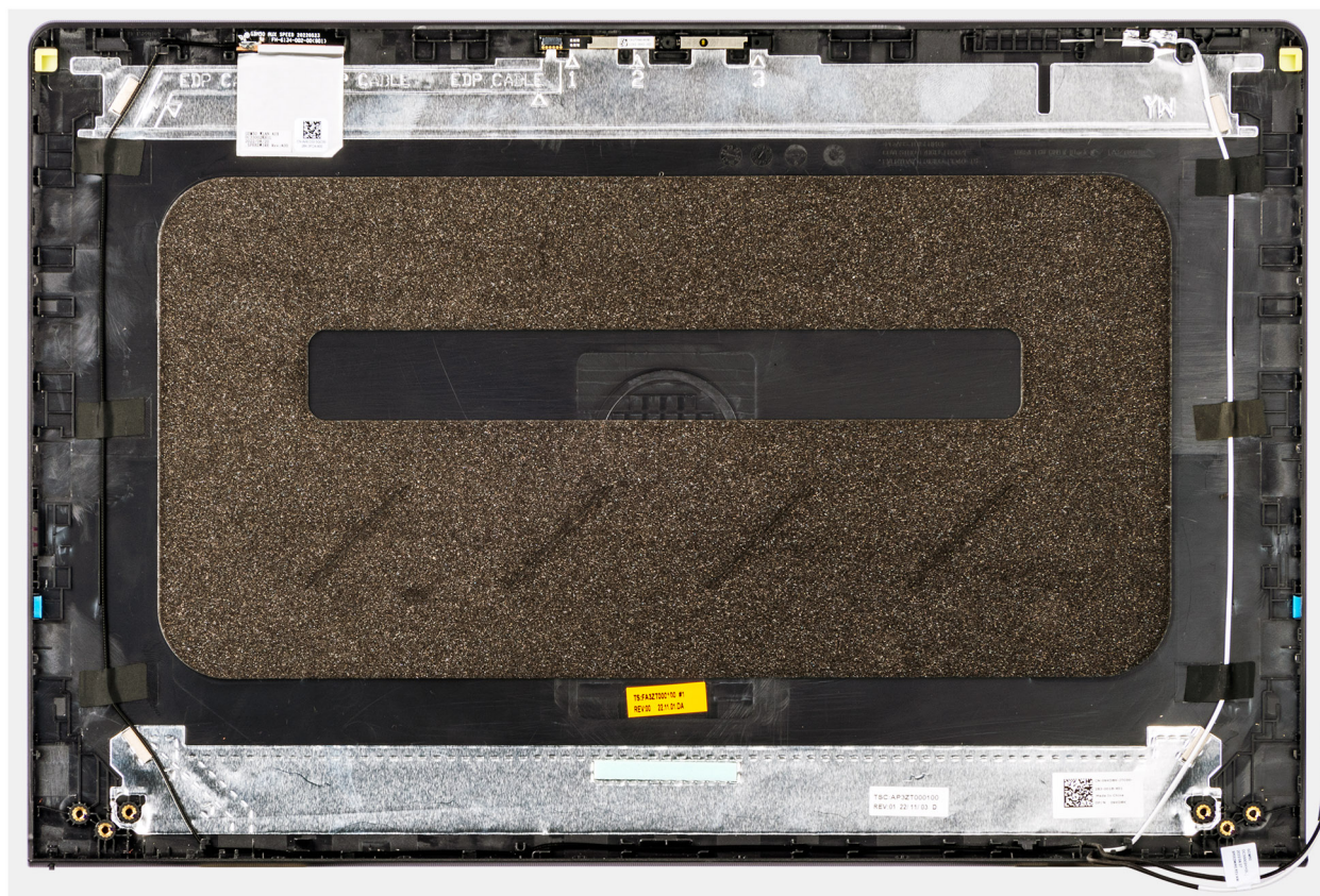
Afbeelding 63. De achterzijde van het beeldscherm en de antenne plaatsen
