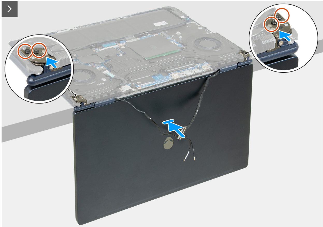
Figura 70. Como instalar o conjunto da tela
