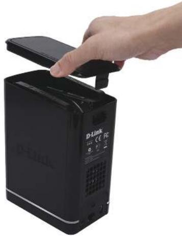
**Schritt 5** - Bringen Sie die Deckenplatte wieder an. Stellen Sie sicher, dass dabei die Verriegelungsklinke in die Platte eingesetzt wird.
