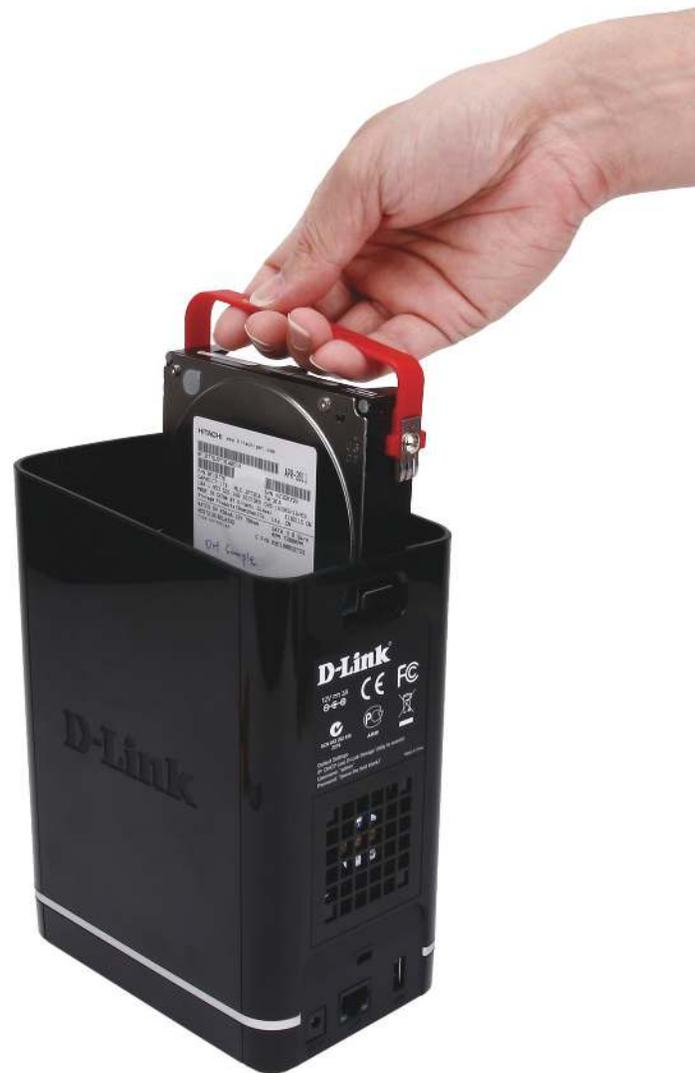
Ziehen Sie das Festplattenlaufwerk an den Griffen aus den SATA-Steckbuchsen.
