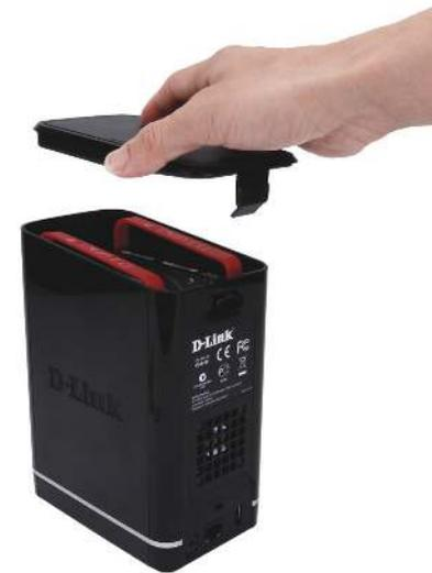
**Schritt 2** - Sobald die Abdeckung entriegelt ist, nehmen Sie sie von dem Gerät. Die Laufwerkschächte des Geräts werden sichtbar.
