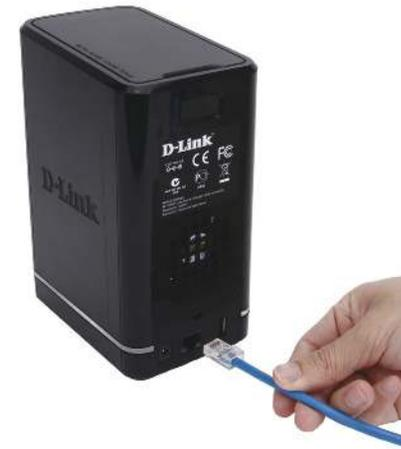
**Step 6** - Schließen Sie ein Ethernet-Kabel an den Ethernet-Port an. Mit diesem Kabel wird das ShareCenter über einen Router oder Switch mit Ihrem lokalen Netzwerk oder direkt mit einem Computer zwecks Konfiguration verbunden (dazu ist die Verwendung eines Cross-over-Kabels erforderlich).
