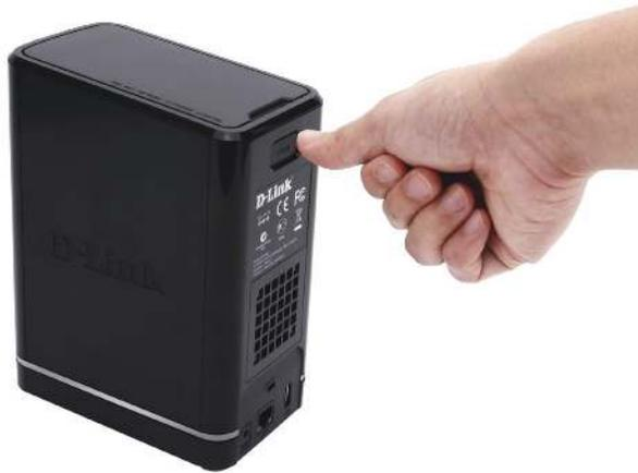
**Schritt 1** - Nehmen Sie die Deckenplatte ab, indem Sie auf der Rückseite des Geräts fest auf die Verriegelungsklinke drücken.
