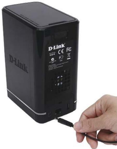
**Step 7** - Schließen Sie das Netzteil an die Steckdose an.
