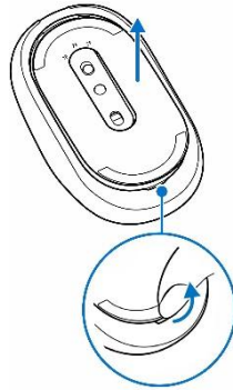
Illustration 5. Ouverture du couvercle de la base
