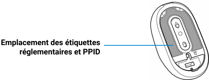
Illustration 3. Emplacement des étiquettes réglementaires et PPID sur la souris
