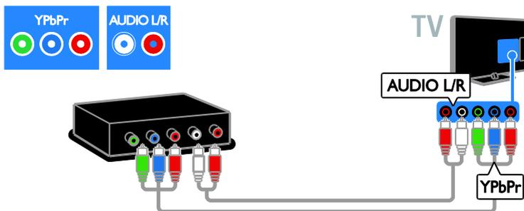
Ligue o gravador ao televisor através de um cabo composto (CVBS) e um cabo de áudio L/R.
