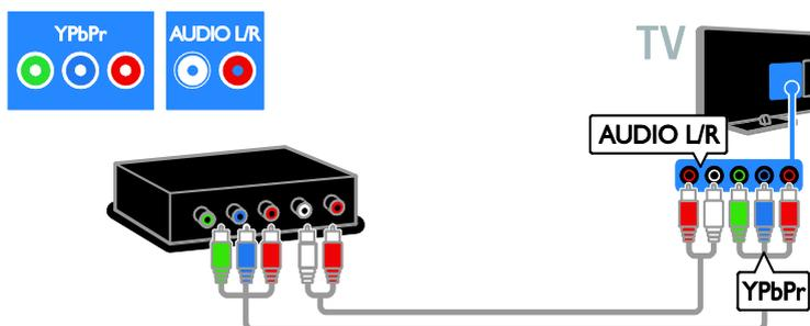
Ligue o leitor de discos ao televisor através de um cabo de componente (Y Pb Pr) e um cabo de áudio L/R.
