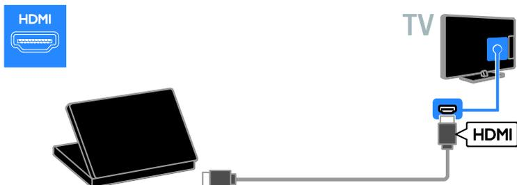
Ligue o computador ao televisor através de um cabo DVI-HDMI e um cabo de áudio.
