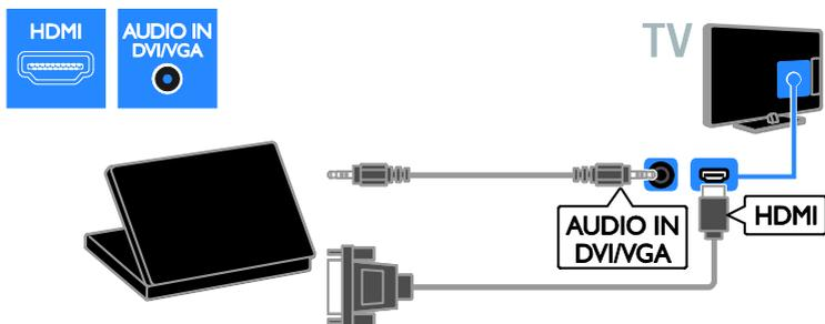
Ligue o computador ao televisor através de um cabo VGA e um cabo de áudio.
