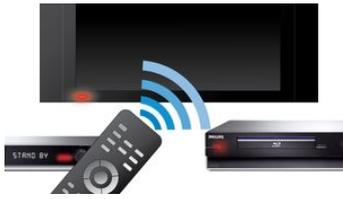
O EasyLink permite-lhe controlar vários dispositivos, como leitores de DVD, leitores Blu-ray, altifalante Soundbar, sistema de cinema em casa, televisores, etc., com um telecomando. Este utiliza o protocolo padrão da indústria, HDMI CEC, para partilhar funcionalidades entre dispositivos através do cabo HDMI. Com o toque de um botão, pode operar simultaneamente todos os
