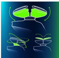
As cabeças de seguimento de contornos GyroFlex 3D da máquina de barbear ajustam-se na perfeição a cada curva do seu rosto, reduzindo a pressão e irritação da pele.
