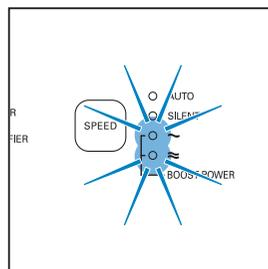
Чтобы изменить скорость работы вентилятора, нажмите кнопку **SPEED**.
