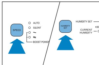
→ На очистителе воздуха дважды раздастся звуковой сигнал, начнет мигать индикатор скорости работы вентилятора ( ~ ), указывающий на текущий уровень чувствительности датчика качества воздуха.
