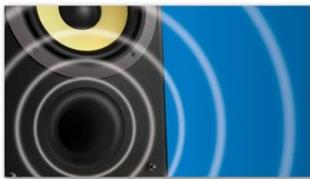
El sistema de altavoces Bass Reflex ofrece unos graves profundos con altavoces de reducidas dimensiones. Se distingue de los sistemas convencionales en que se ha añadido un túnel de graves alineado acústicamente con el woofer, que optimiza el límite de baja frecuencia del sistema. El resultado son unos graves mejor controlados, más profundos y con menor distorsión. El sistema hace resonar la masa de aire en el túnel de graves para que vibre como un woofer convencional. Junto con la respuesta
