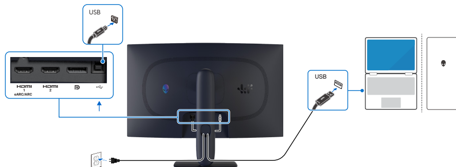
Afbeelding 26. De USB Type-B (Type-B naar Type-A)-kabel aansluiten
