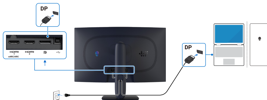
Afbeelding 24. De DisplayPort (DP naar DP)-kabel aansluiten
