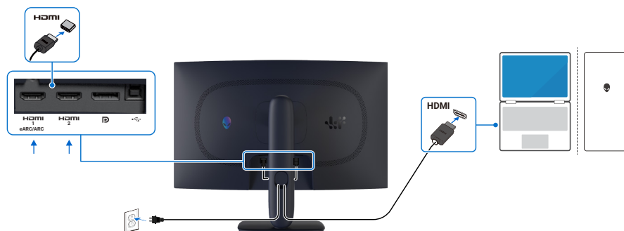
Afbeelding 25. De HDMI-kabel aansluiten
