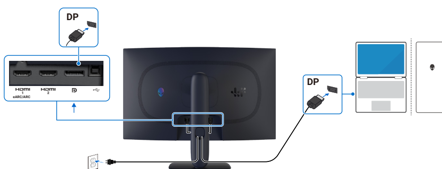
Figure 9. Branchement du câble DisplayPort (DP à DP)
