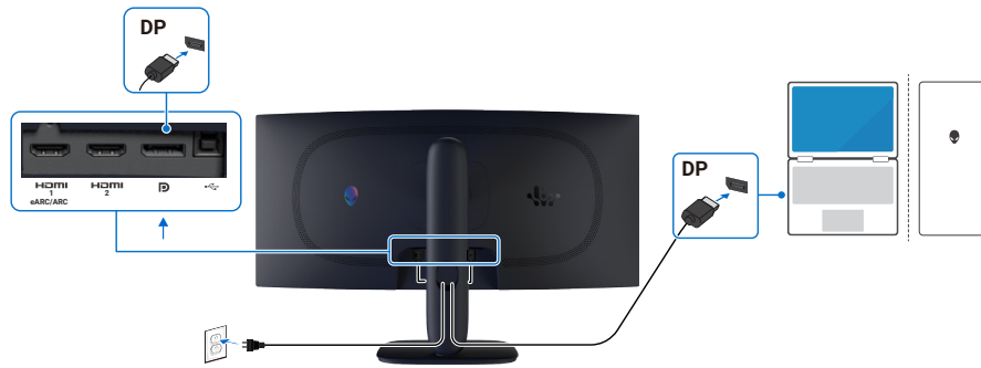
Figure 9. Branchement du câble DisplayPort (DP à DP)
