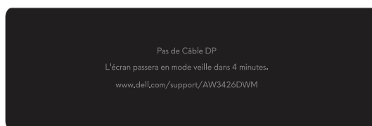
Figure 39. Message d'avertissement - Pas de câble DP
