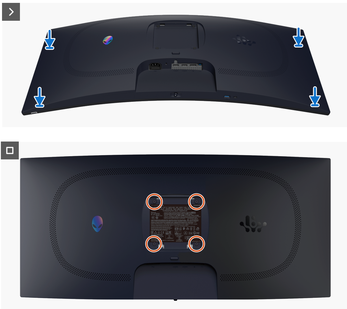
Figure 20. Installer le couvercle arrière
