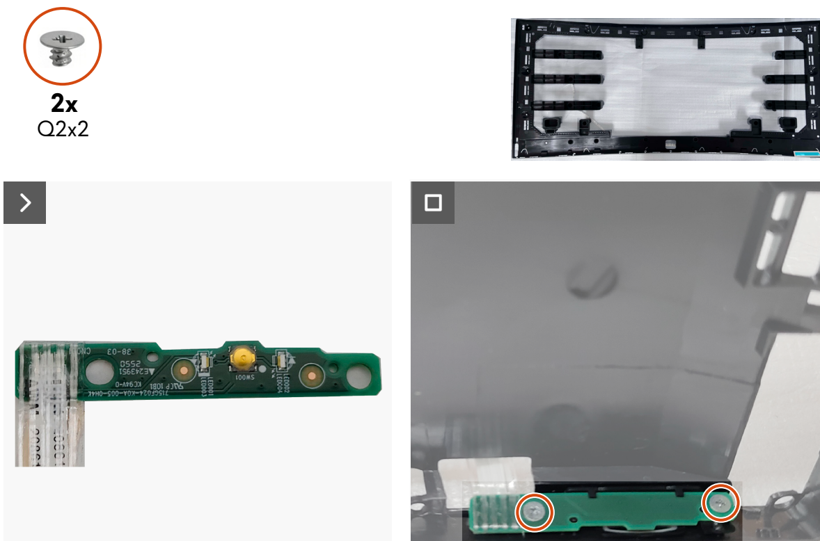
Figure 38. Installer la carte du bouton-alimentation
