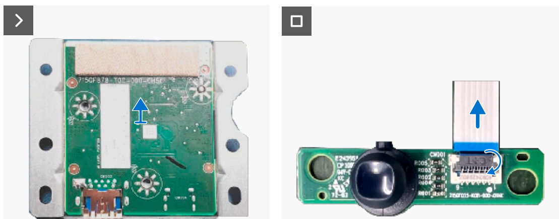
Figure 22. Enlever la carte d'E/S et la carte du bouton-joystick
