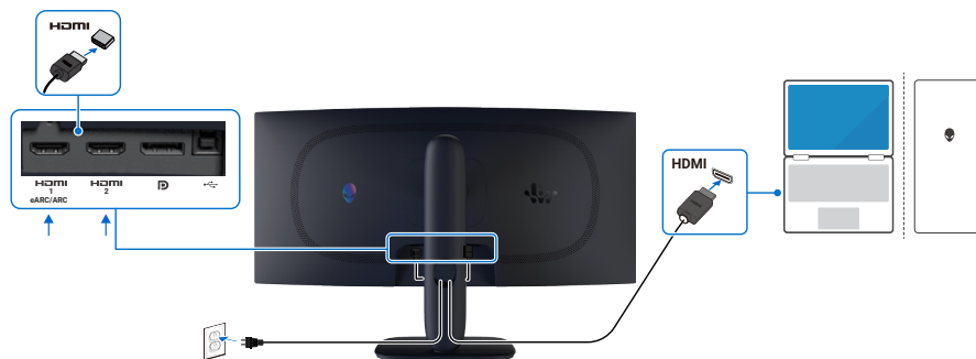
Figure 10. Branchement du câble HDMI
