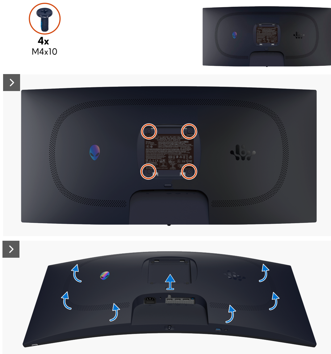
Figure 17. Enlever le couvercle arrière
