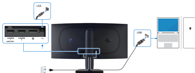
Figure 11. Branchement du câble USB type B (type B à type A)
