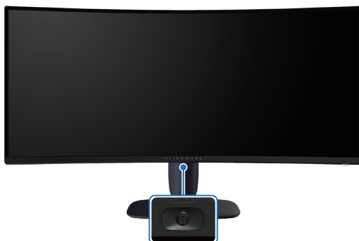
Afbeelding 31. De joystickbediening gebruiken
