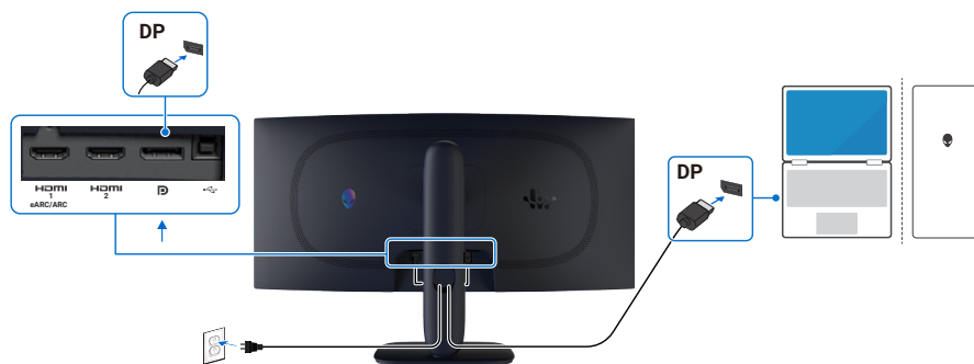
Afbeelding 24. De DisplayPort (DP naar DP)-kabel aansluiten
