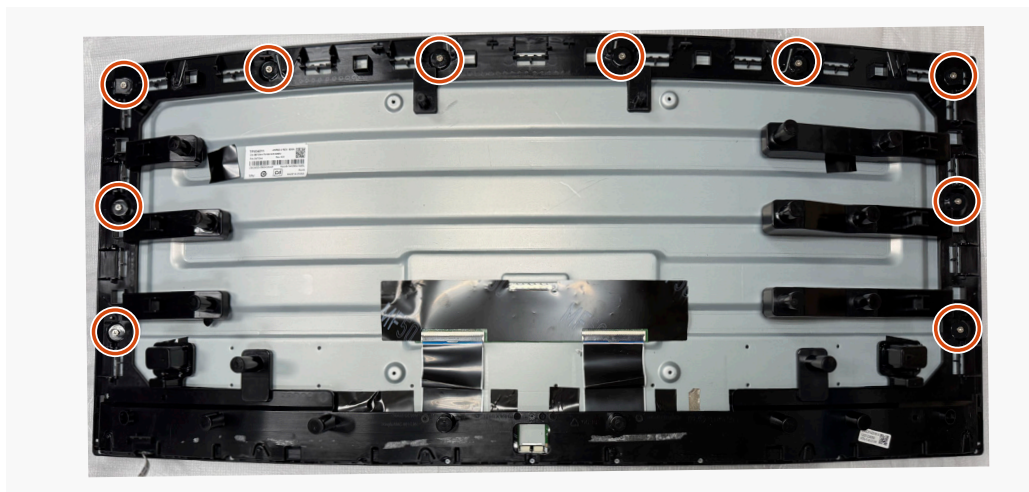
Rysunek 33. Zdejmowanie ramki środkowej
