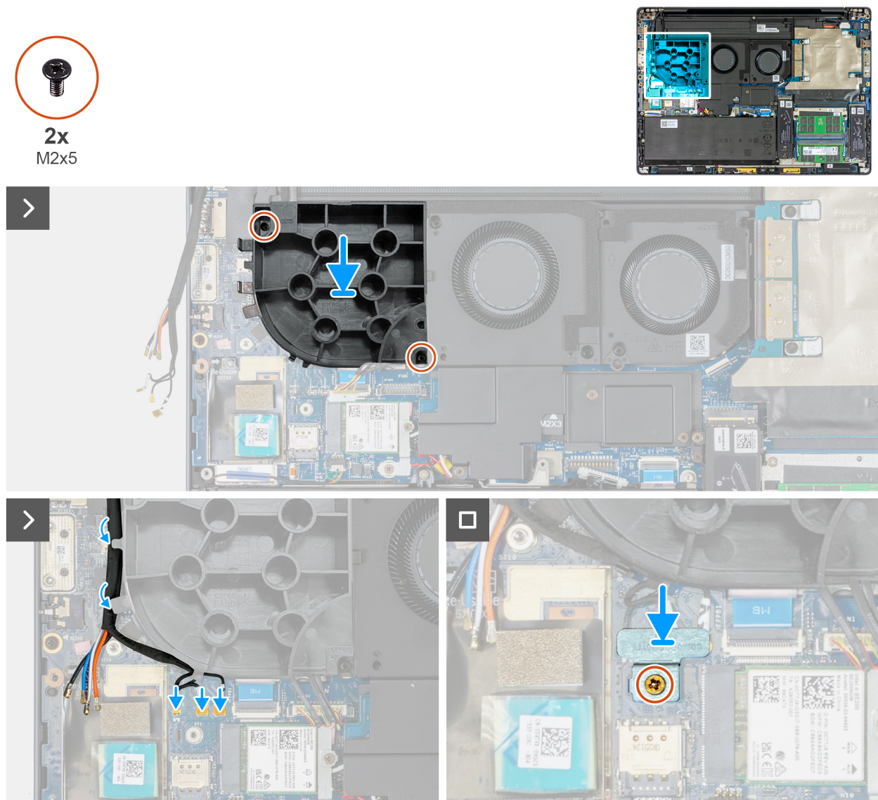
Afbeelding 58. De dummyventilator installeren
