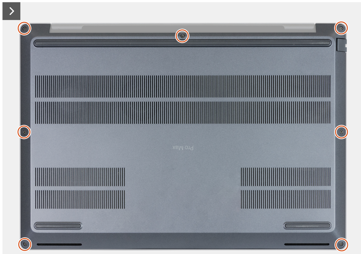
Afbeelding 24. De geborgde schroeven losdraaien
