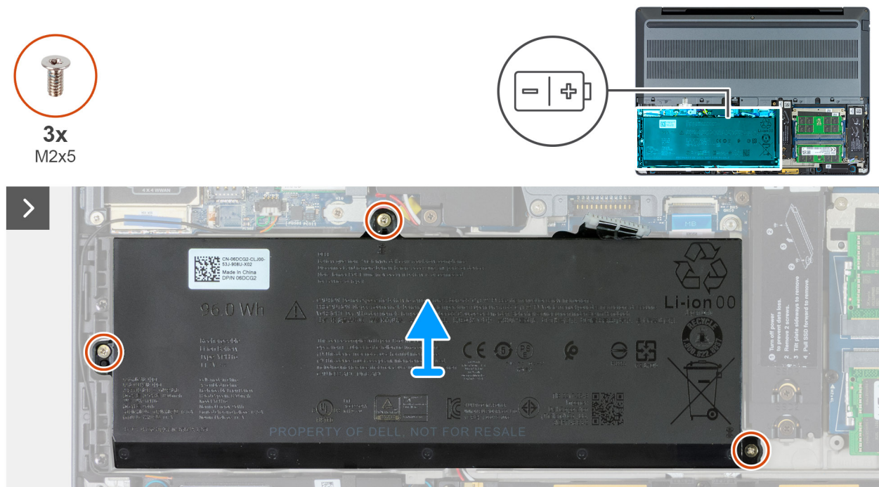
Afbeelding 42. De batterij verwijderen
