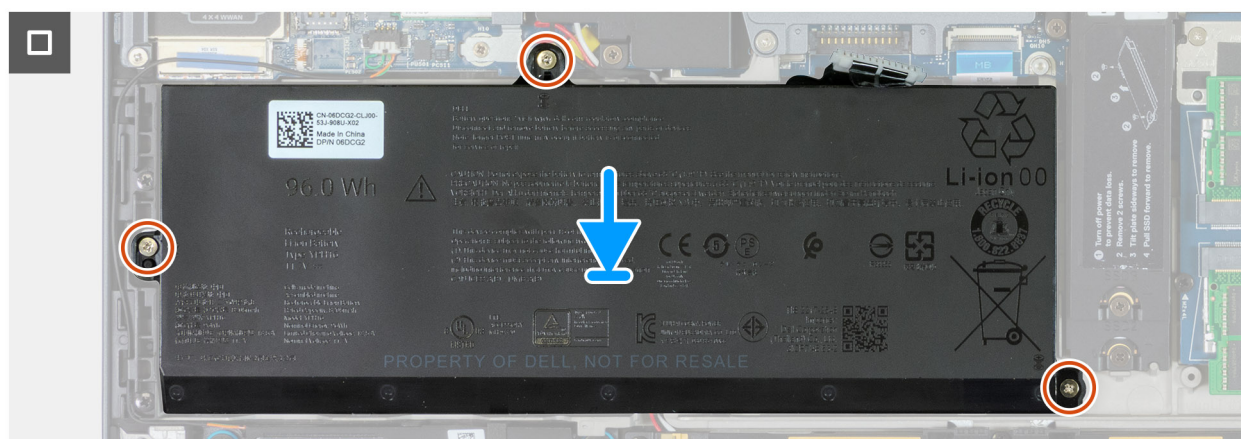
Afbeelding 41. De batterij vervangen
