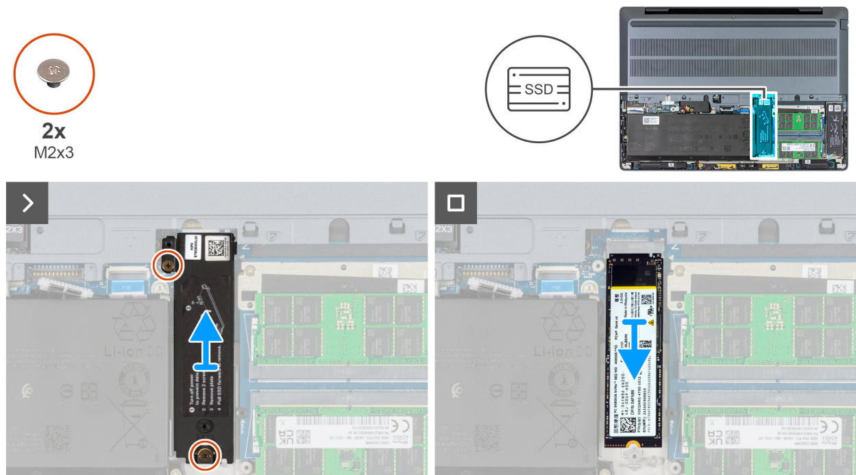
Afbeelding 36. De M.2 2280 SSD verwijderen uit slot 2 (SSD2)
