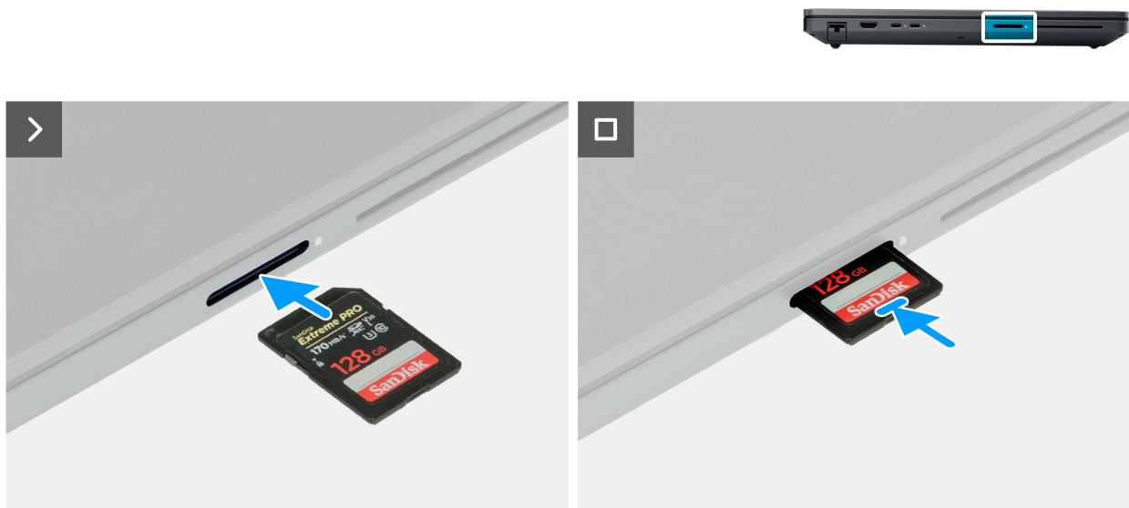
Afbeelding 11. De SD-kaart installeren
