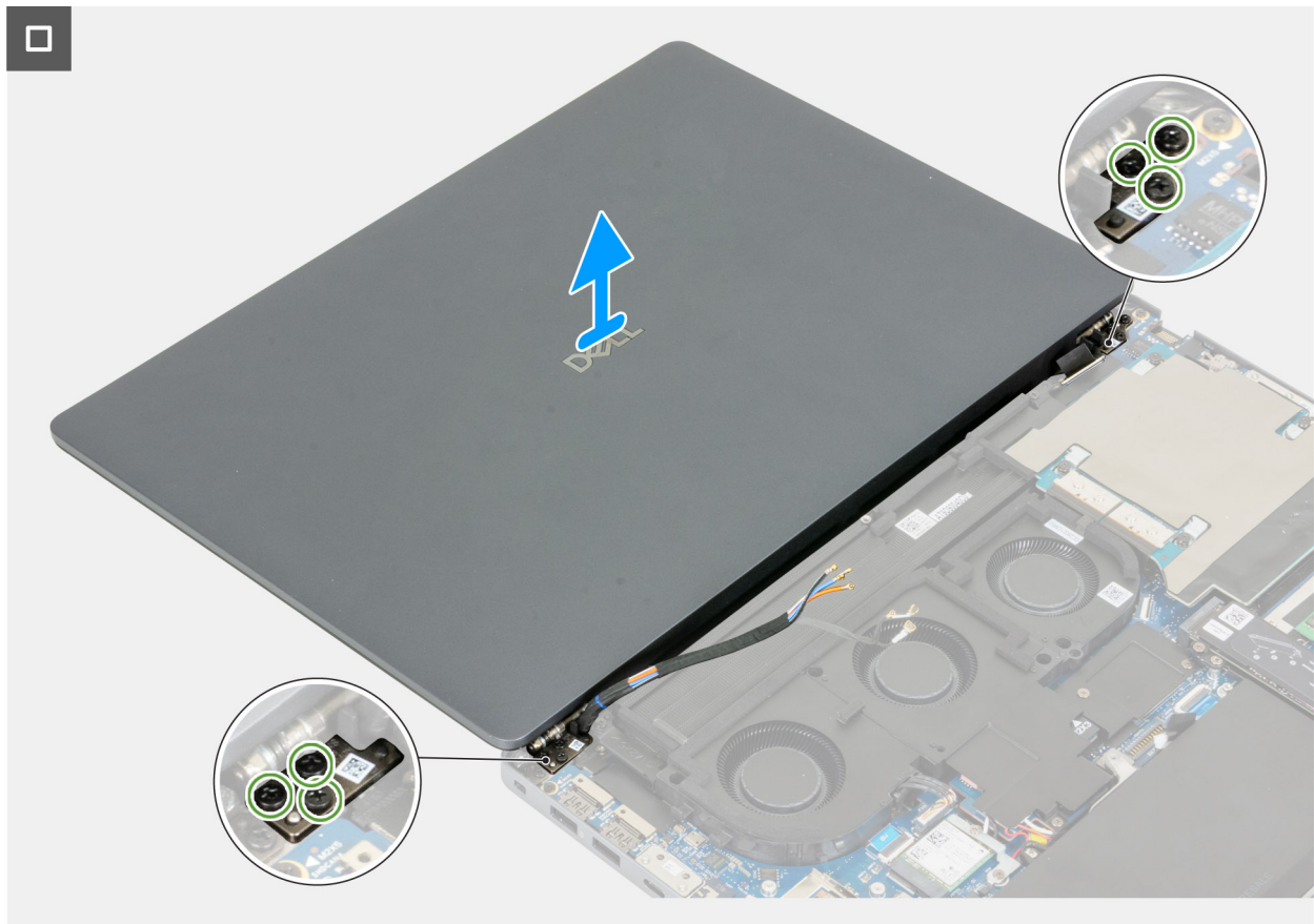
Afbeelding 67. De beeldschermeenheid verwijderen
