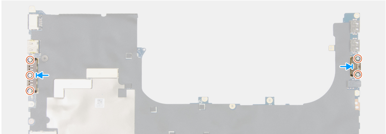
Afbeelding 119. De USB Type-C-connectormodule installeren
