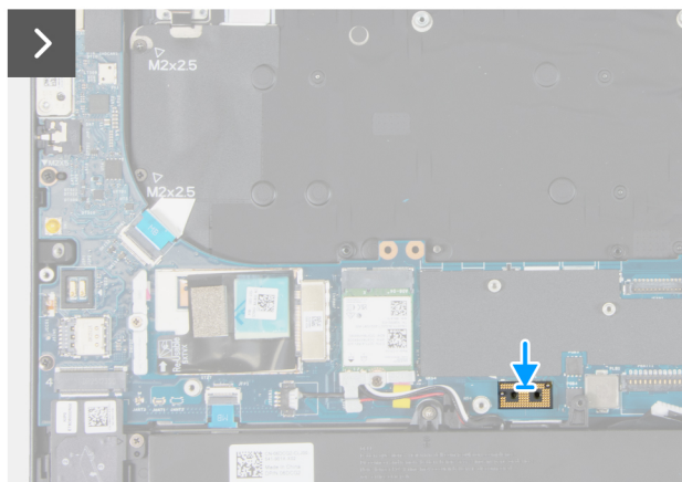
Afbeelding 72. De voedingskaart installeren
