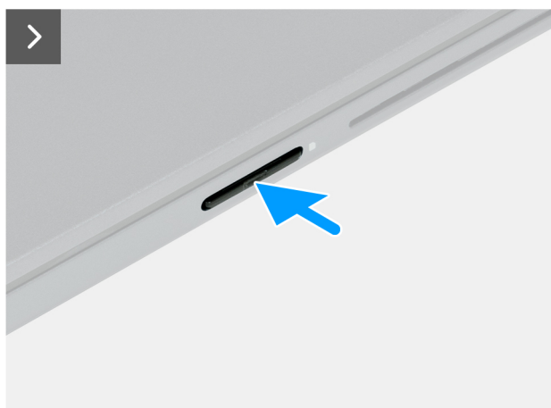
Afbeelding 10. De SD-kaart verwijderen
