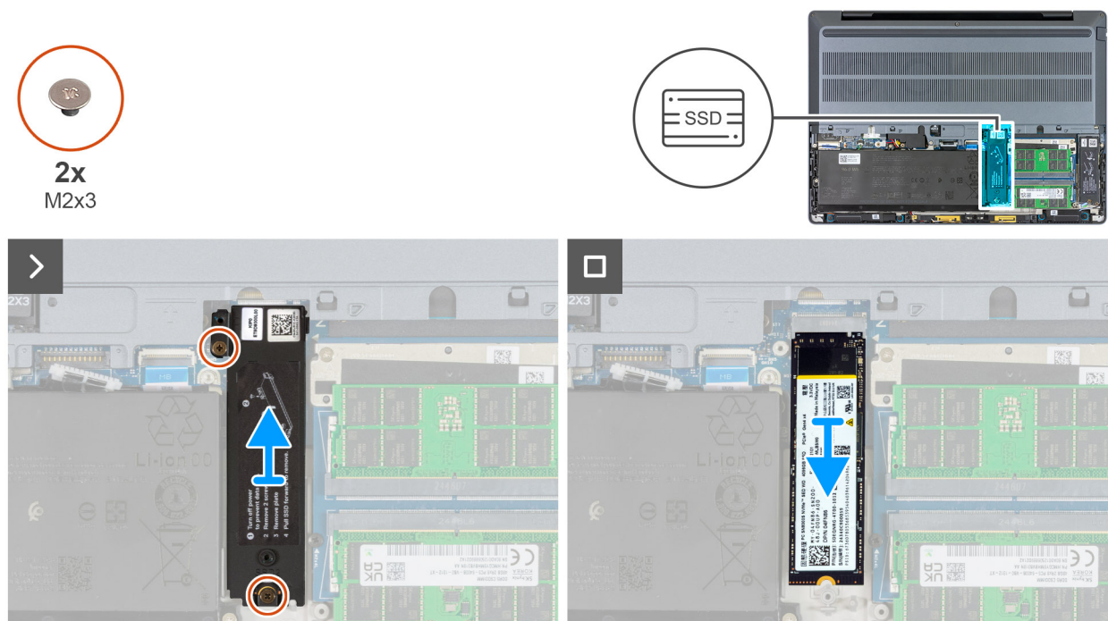
Afbeelding 38. De M.2 2280 SSD verwijderen uit slot 2 (SSD2)
