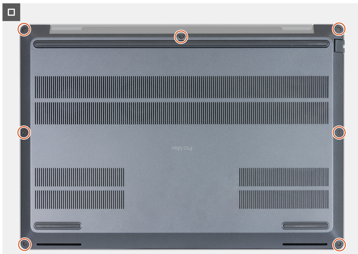
Afbeelding 29. De geborgde schroeven vastdraaien
