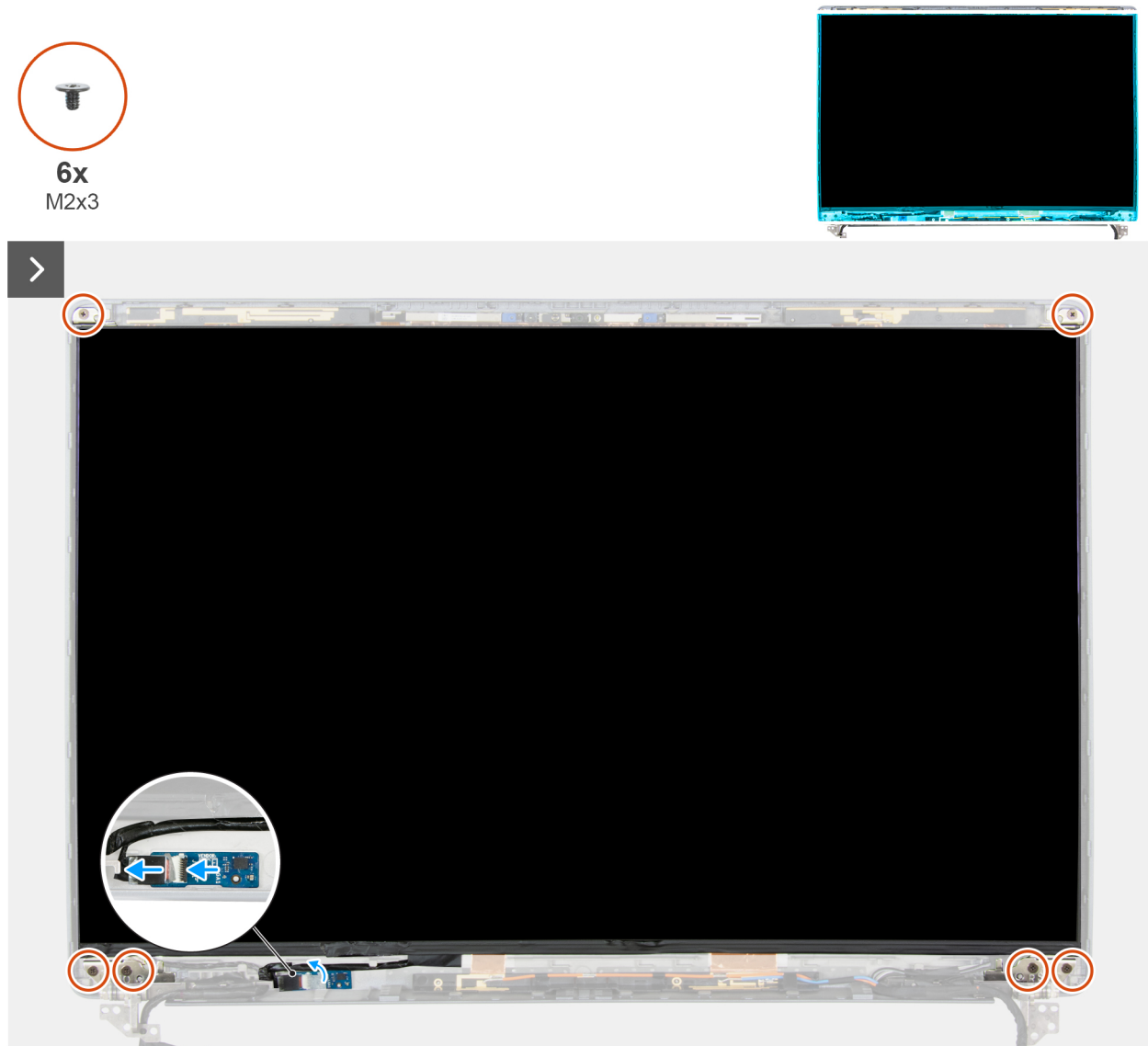
Afbeelding 95. Het beeldschermpaneel verwijderen
