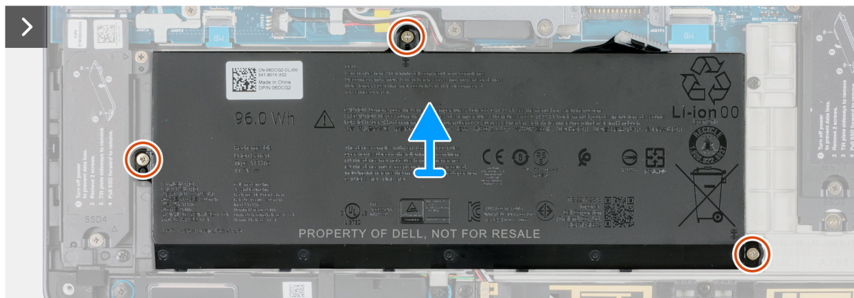
Afbeelding 44. De batterij verwijderen
