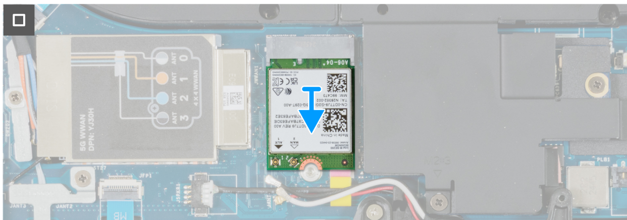
Afbeelding 48. De WLAN-kaart verwijderen
