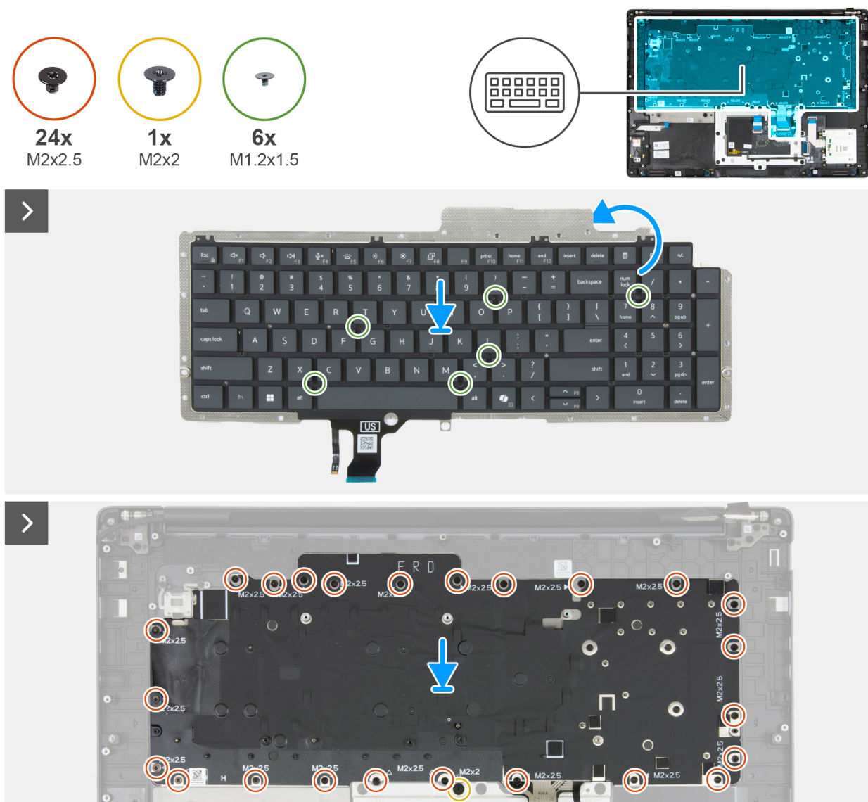
Afbeelding 119. Het toetsenbord installeren
