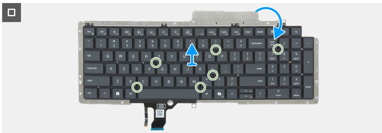
Afbeelding 118. Het toetsenbord verwijderen
