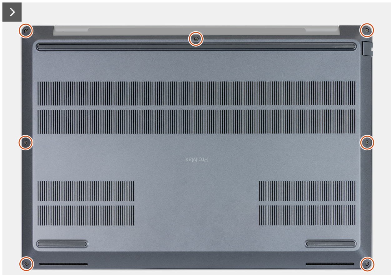
Afbeelding 24. De geborgde schroeven losdraaien
