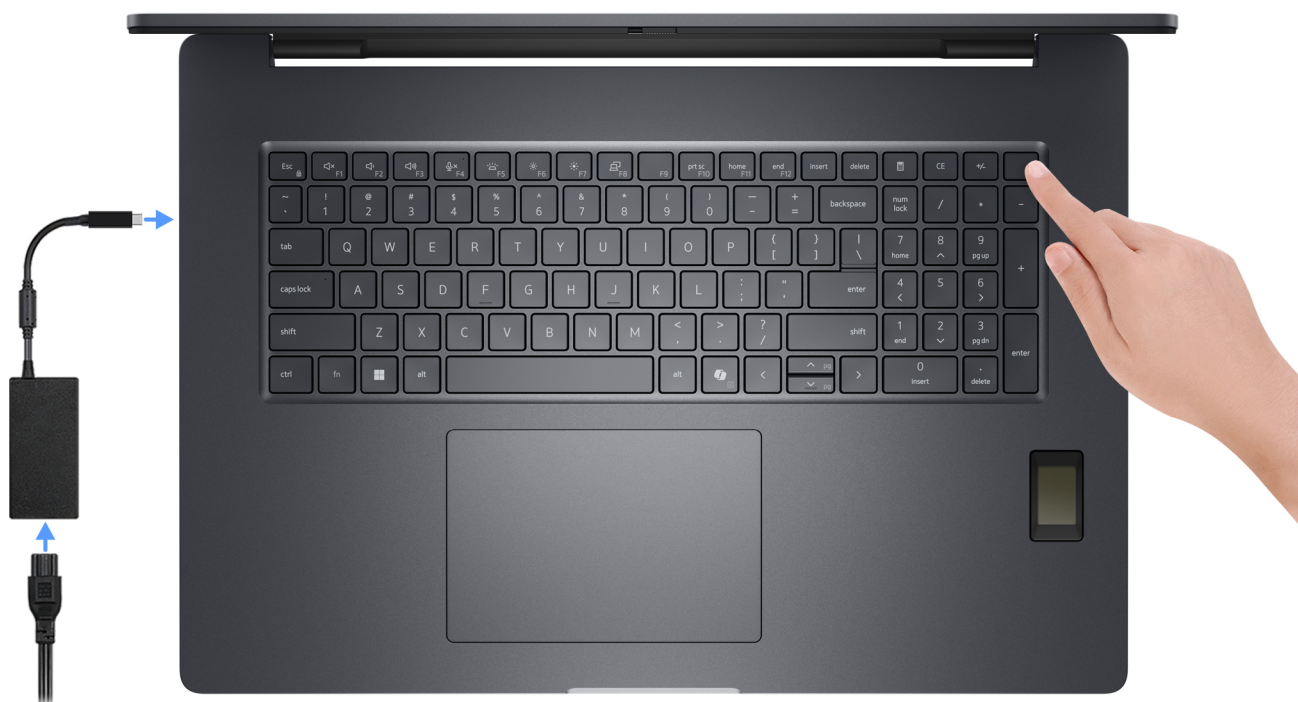
Afbeelding 7. Sluit de voedingsadapter aan en druk op de aan-uitknop.
