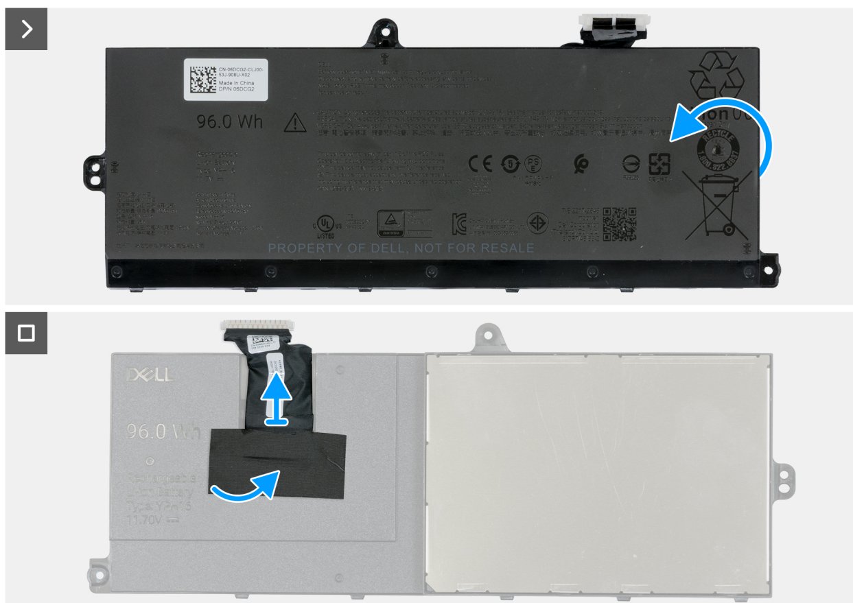
Afbeelding 45. De batterijkabel uit de batterij verwijderen
