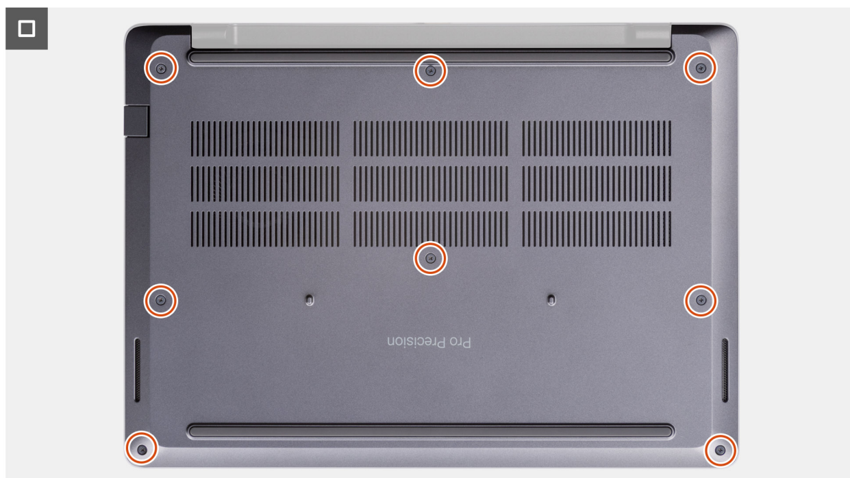
Afbeelding 5. Installing the base cover
