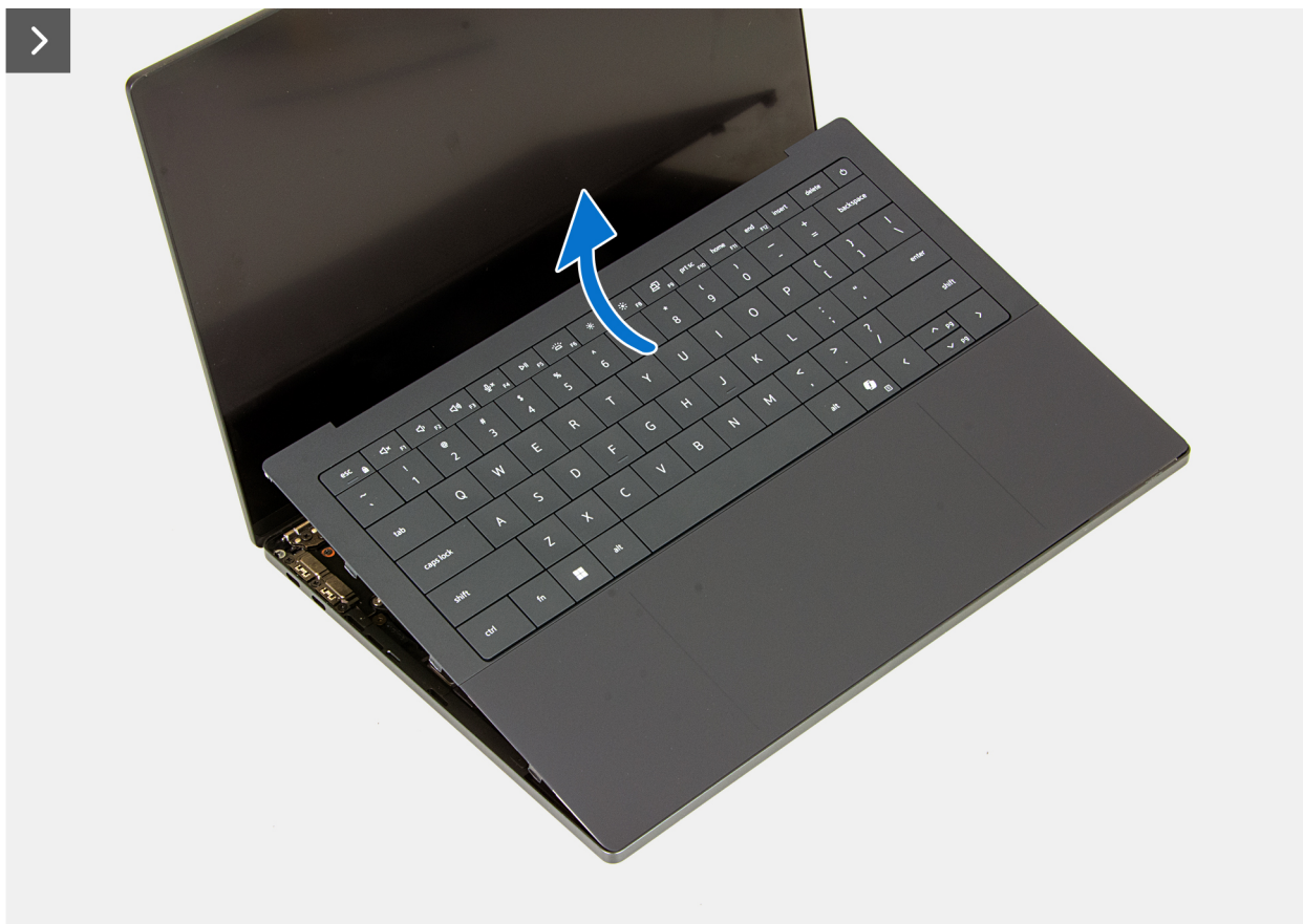
Figura 4. Sollevare delicatamente il gruppo del poggiapolsi e tastiera dal coperchio della base
