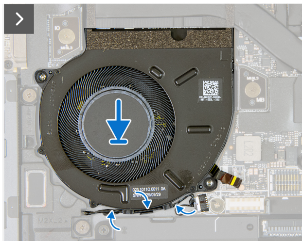
Figura 22. Installazione della ventola termica sinistra
