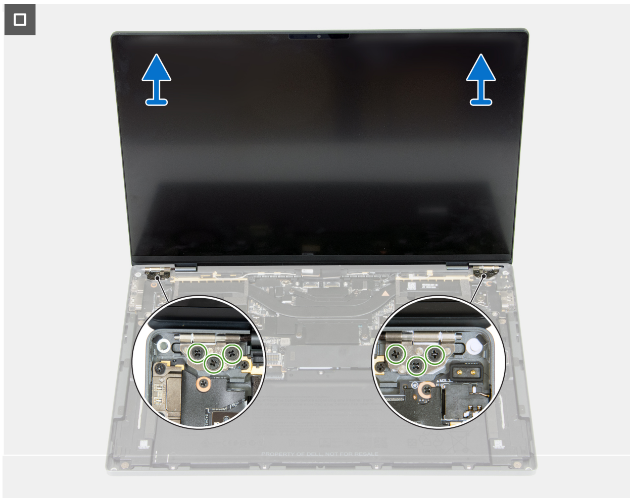
Figura 18. Rimozione del gruppo del display
