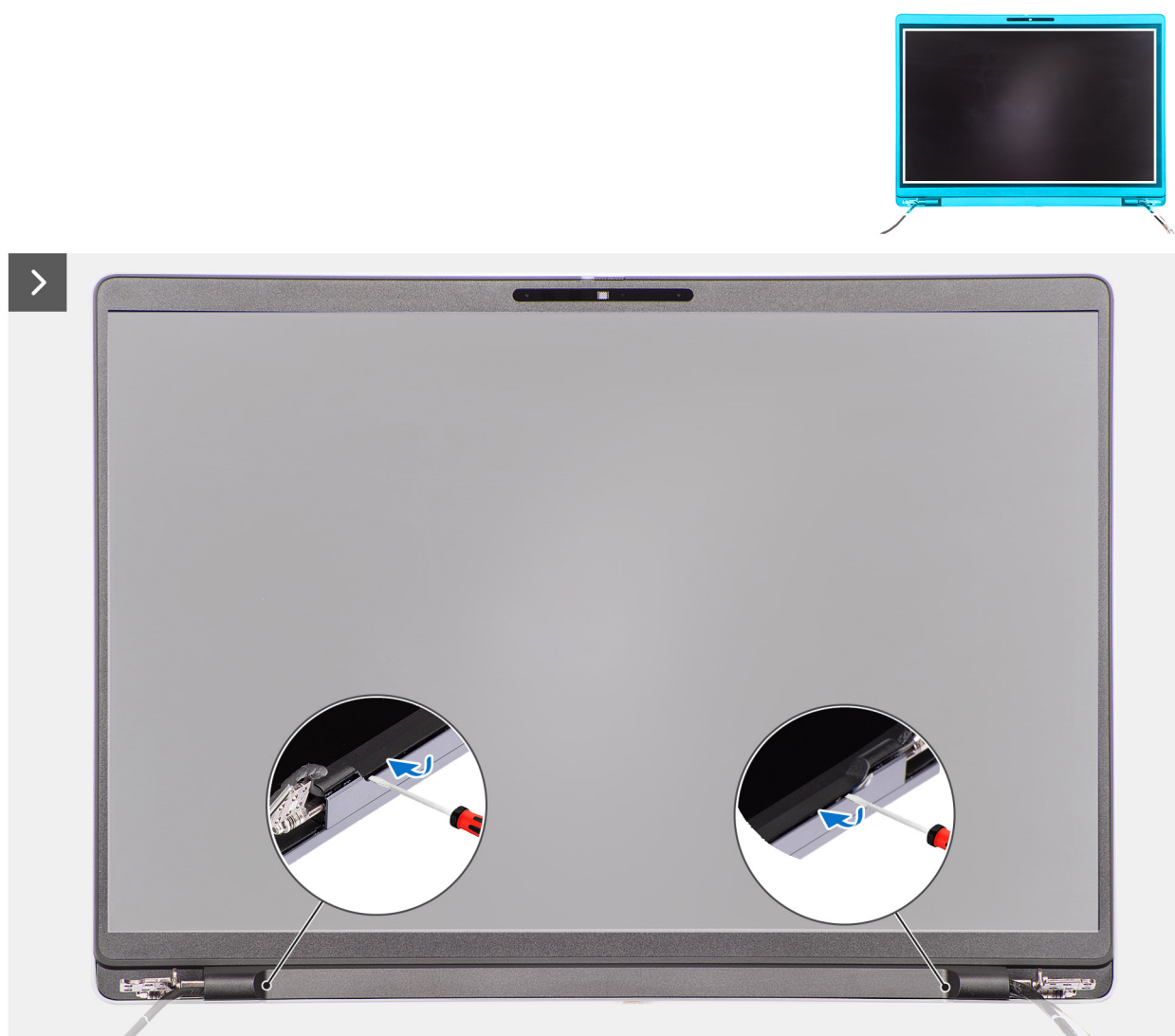
Figura 48. Removing the display bezel
