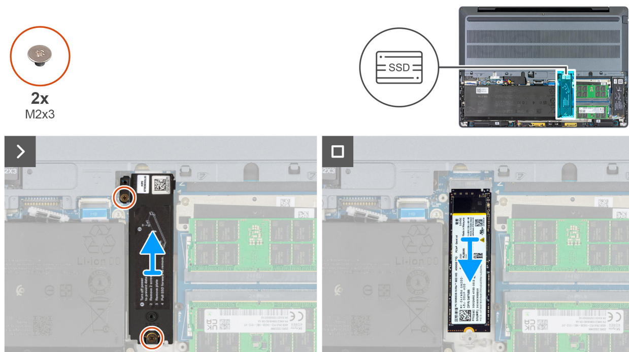
Figure 38. Retrait du disque SSD M.2 2280 du logement 2 (SSD2)
