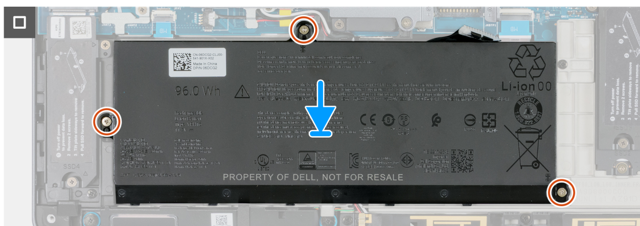
Figure 47. Remise en place de la batterie
