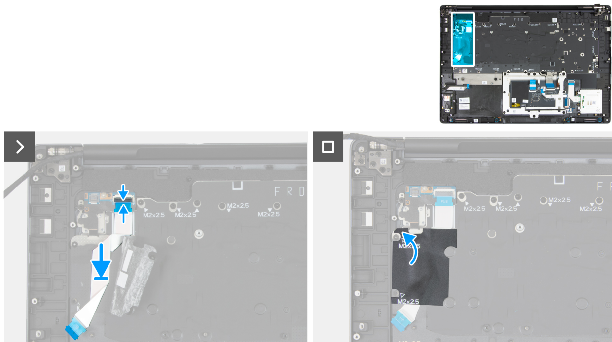
Figure 124. Installation du câble de la carte du bouton d'alimentation
