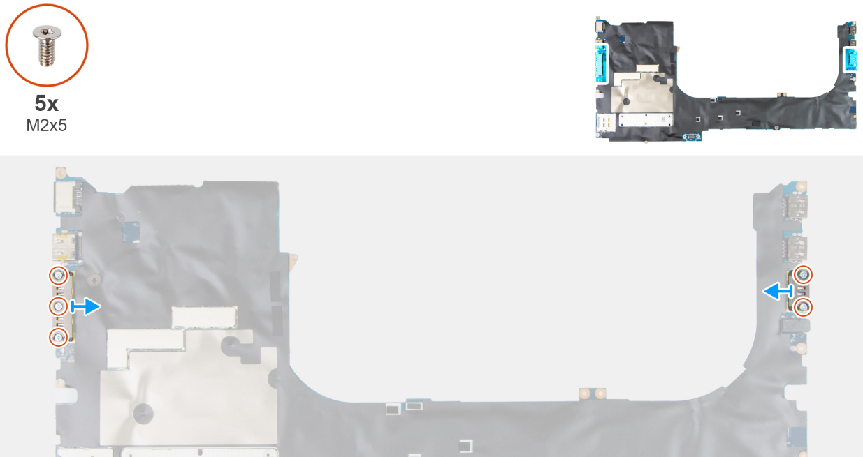
Figure 113. Retrait du module de connecteur USB-C
