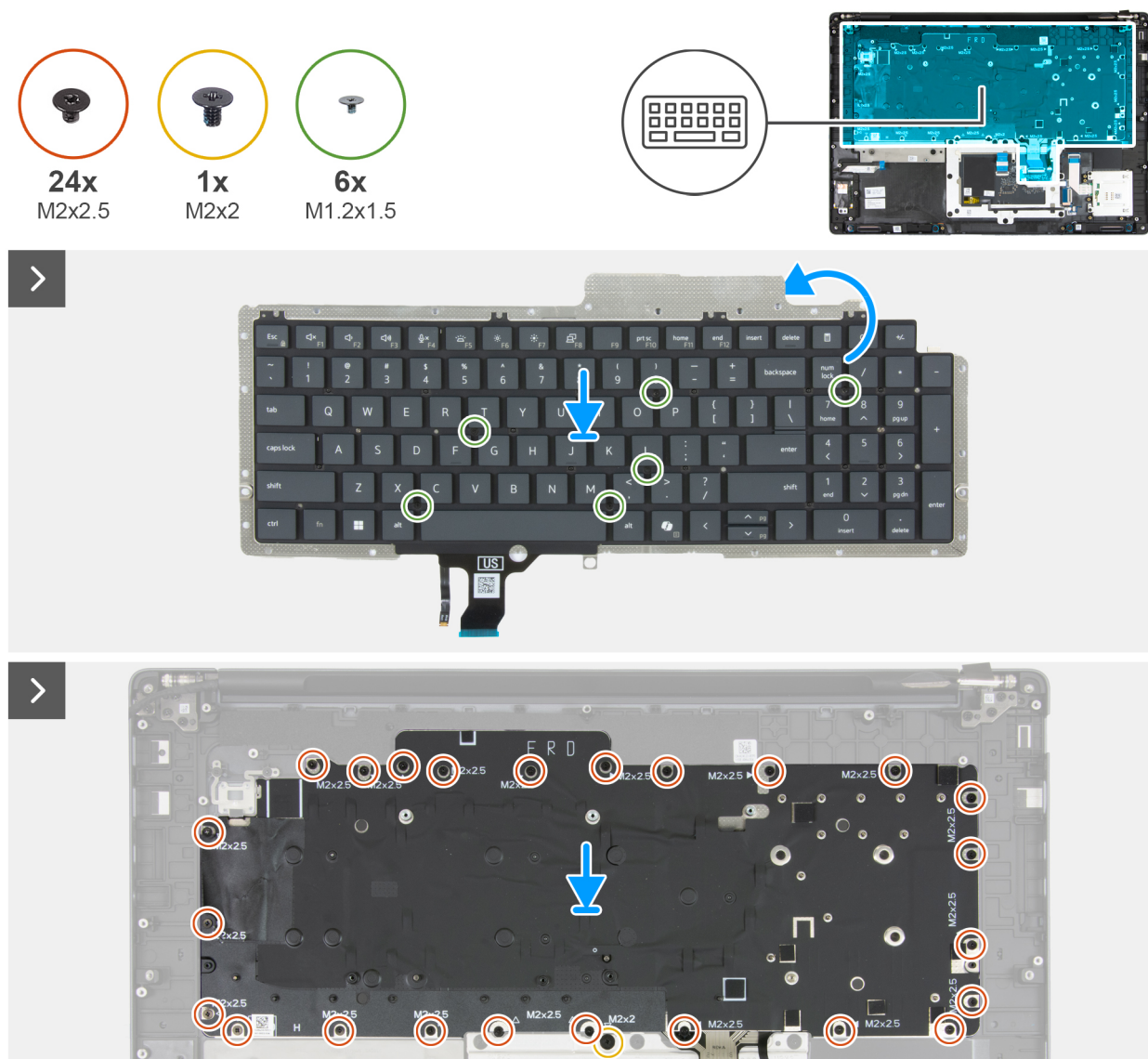
Ilustración 119. Instalación del teclado
