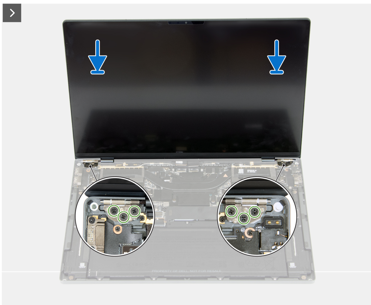
Ilustración 19. Instalación del ensamblaje de la pantalla
