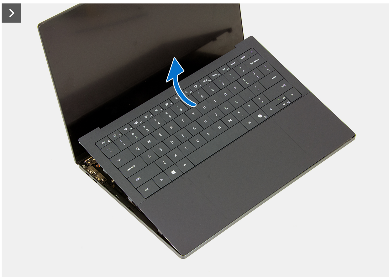
Ilustración 4. Levante con cuidado el ensamblaje del teclado y el reposamanos para quitarlo de la cubierta de la base
