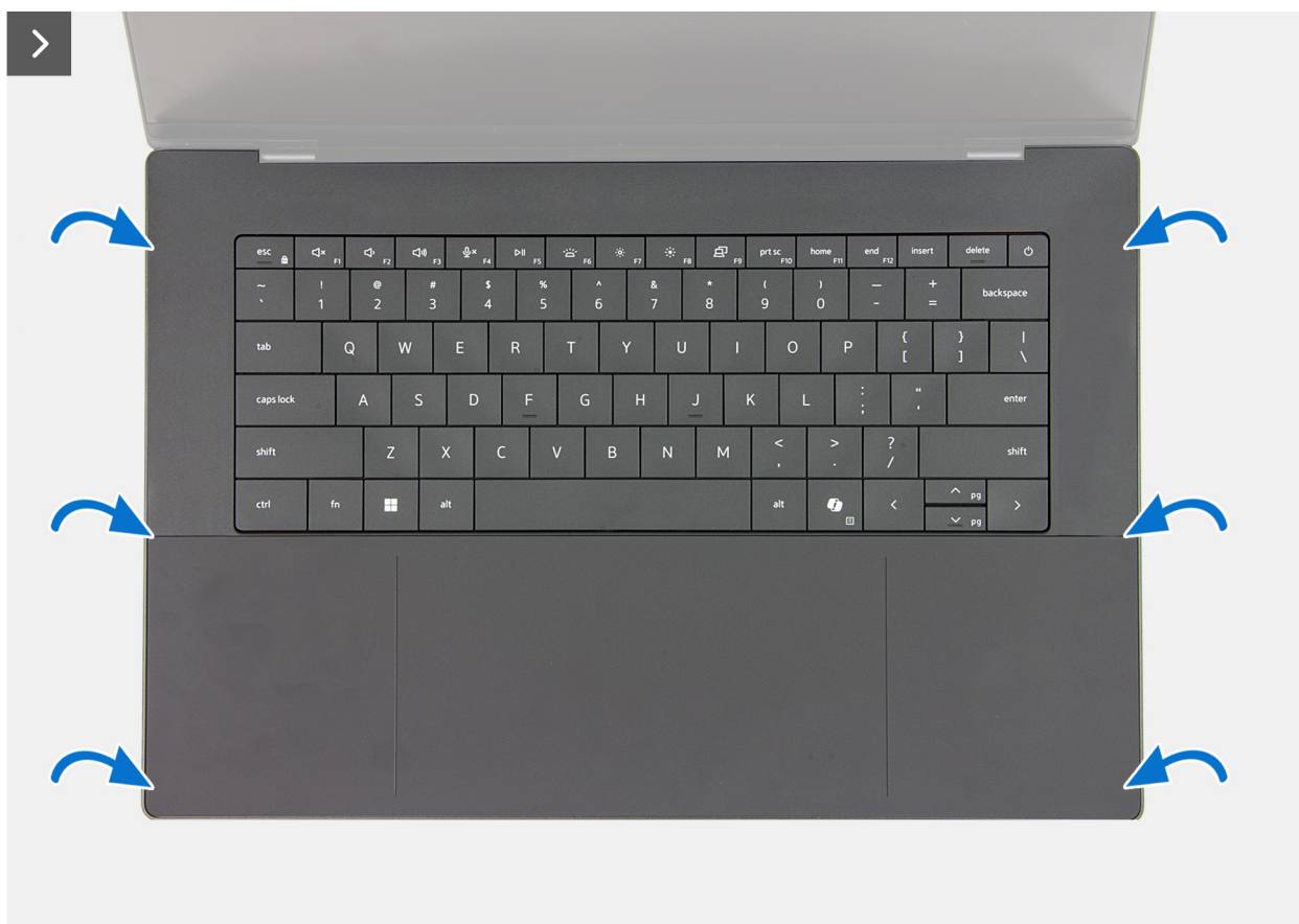
Ilustración 7. Alinee y encaje el ensamblaje del teclado y del reposamanos en su posición en la cubierta de la base
