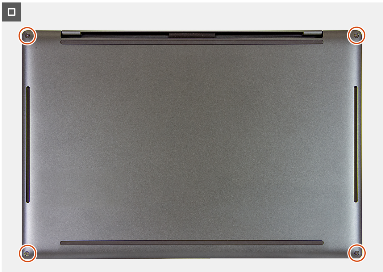
Ilustración 8. Ajuste los cuatro tornillos (M2x3.9, Torx 5) que aseguran la cubierta de la base al ensamblaje del teclado y el reposamanos
