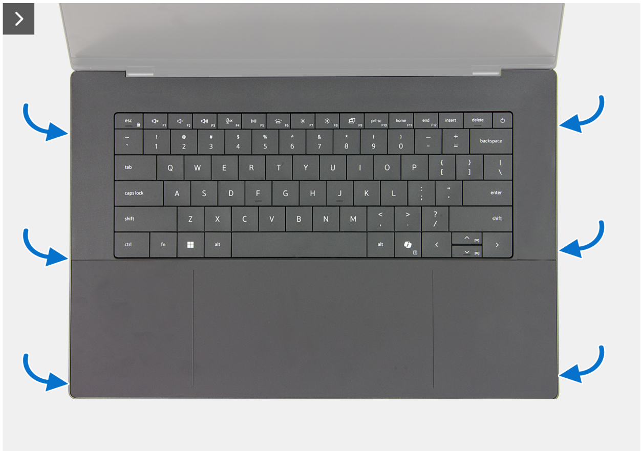
Ilustración 3. Afloje el ensamblaje del teclado y el reposamanos de la cubierta de la base
