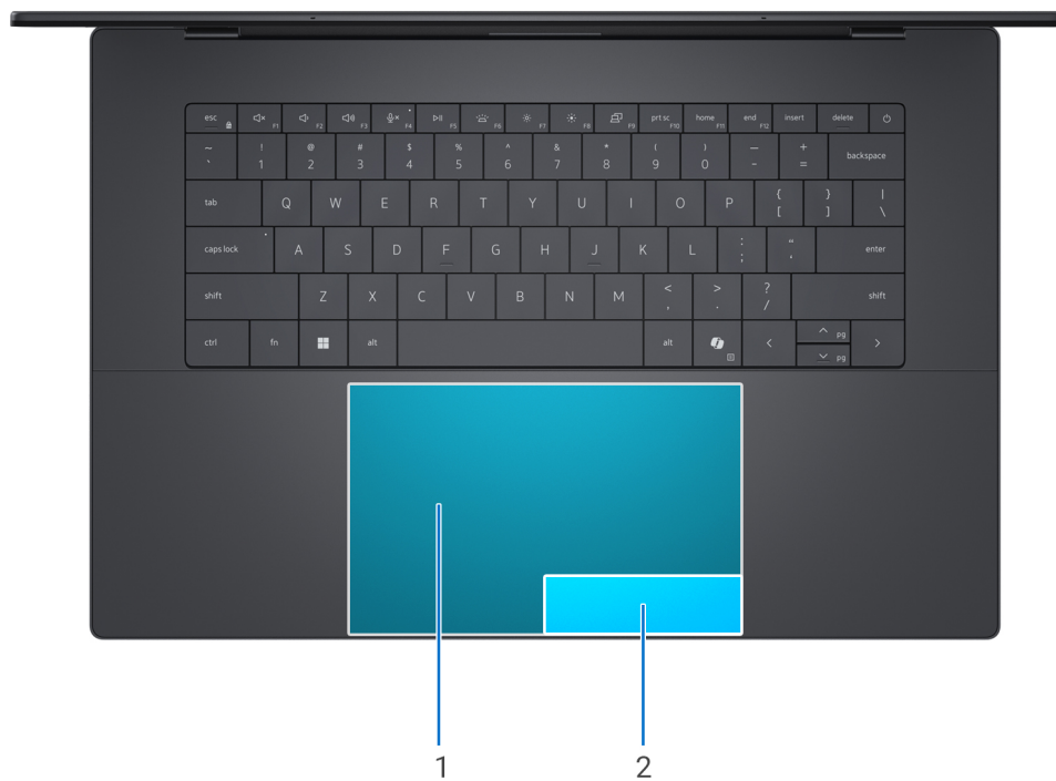
Ilustración 8. Áreas activas del panel táctil integrado
