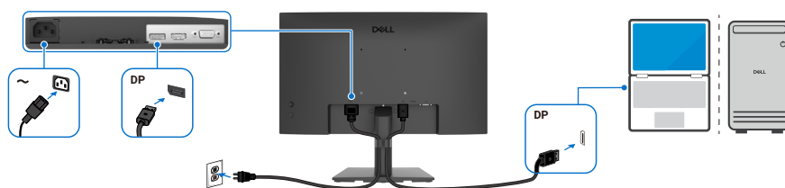
Afbeelding 16. De DP-kabel aansluiten
