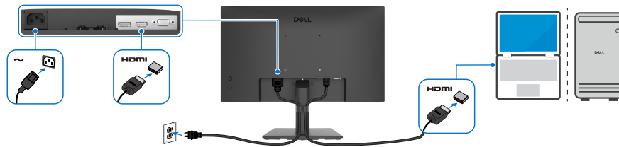
Afbeelding 17. De HDMI-kabel aansluiten
