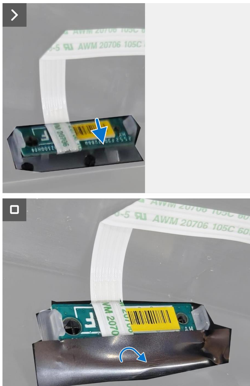
Rysunek 23. Instalacja płyty LED
