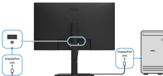
Bilder 15. Ansluta DP-kabeln
