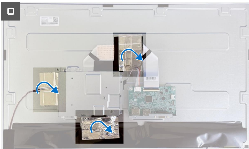
Figura 26. Instalar el conjunto del chasis
