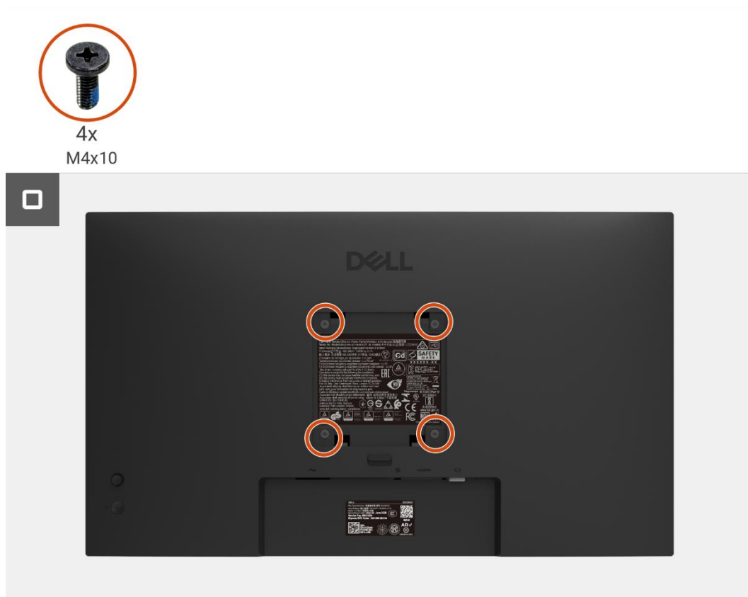
Figura 8. Instalar la cubierta posterior
