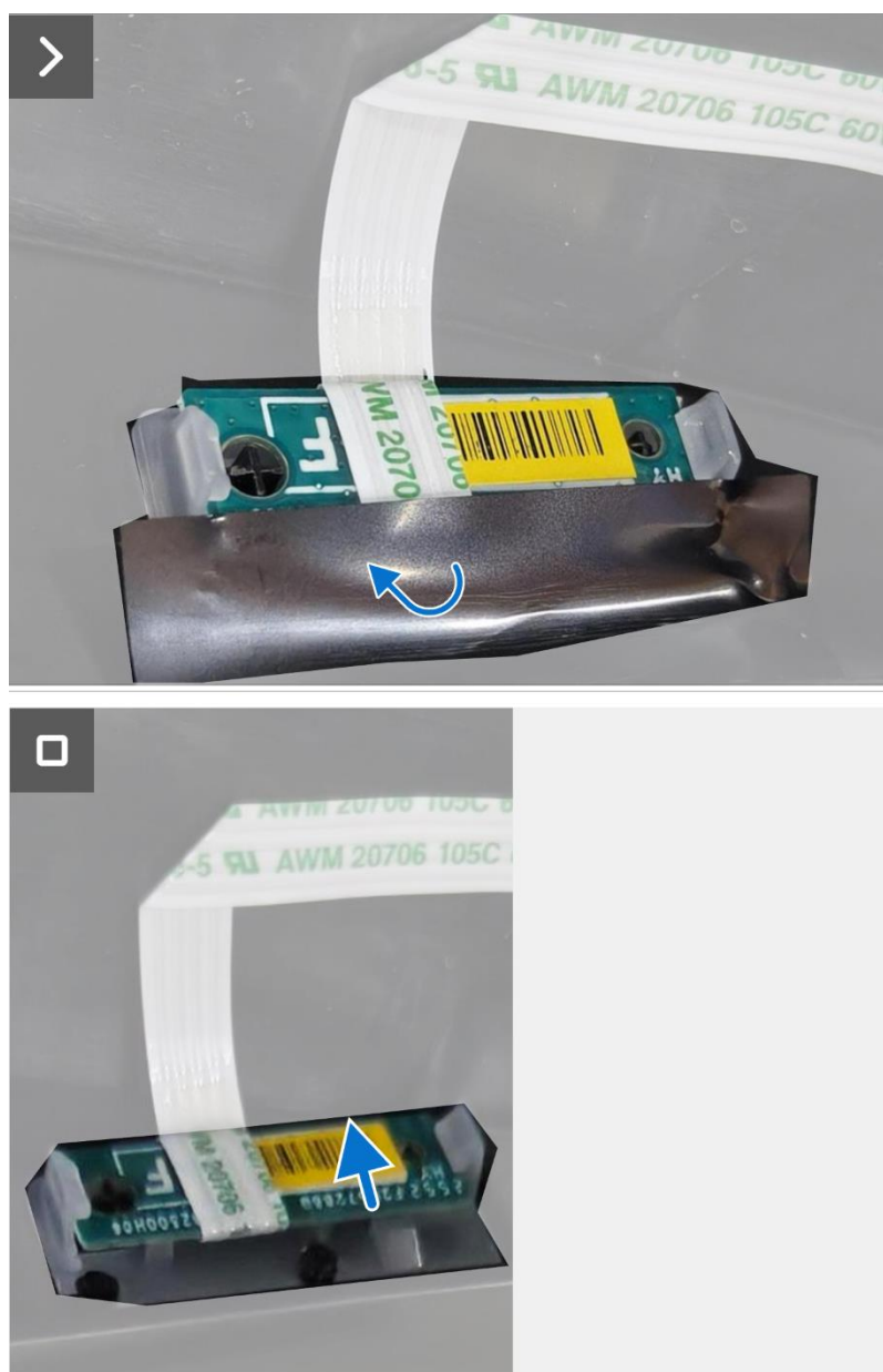
Figura 13. Retirar la placa LED
