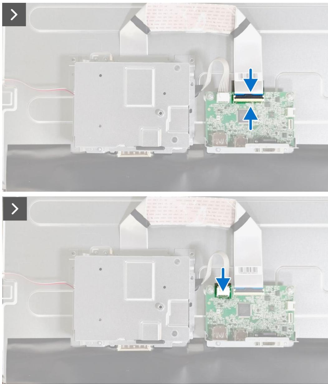
Figura 24. Instalar el conjunto del chasis
