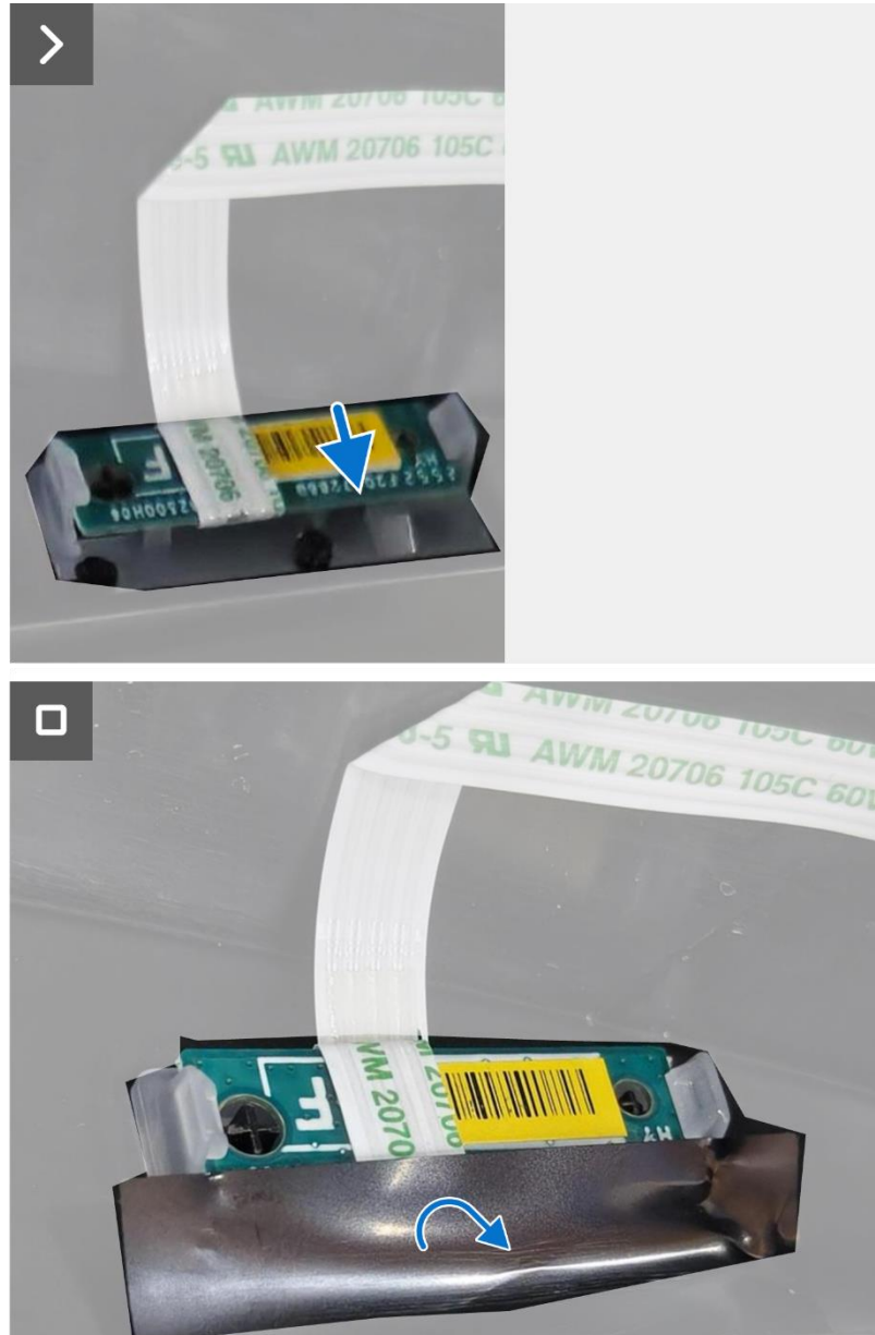
Figura 14. Instalar la placa LED
