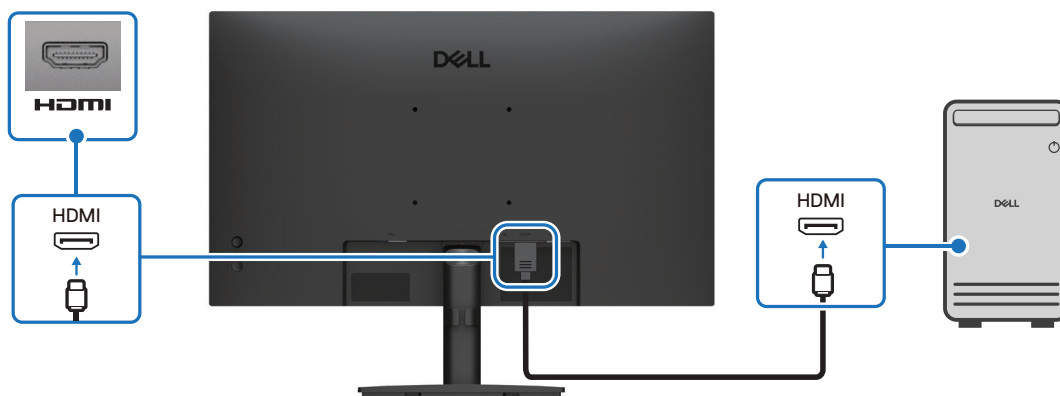
Afbeelding 14. De HDMI-kabel aansluiten
