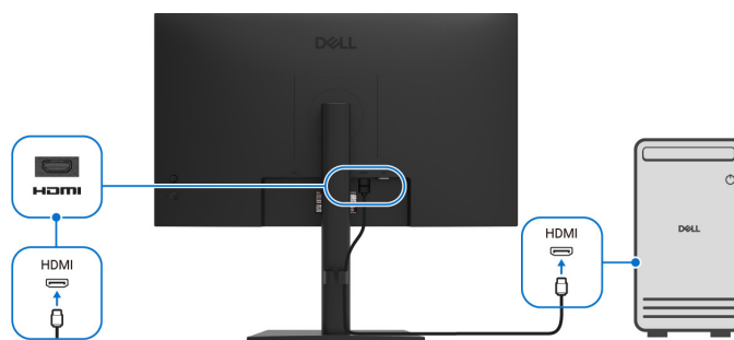
Afbeelding 16. De HDMI-kabel aansluiten
