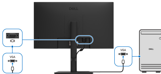
Afbeelding 14. De VGA-kabel aansluiten
