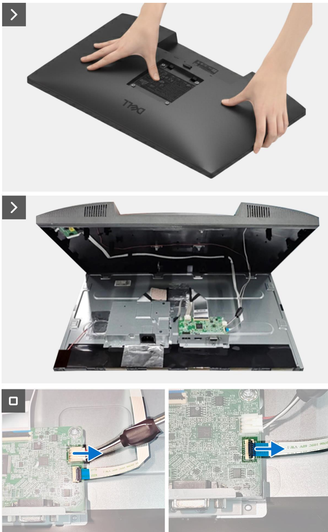
Rysunek 6. Zdejmowanie tylnej pokrywy
