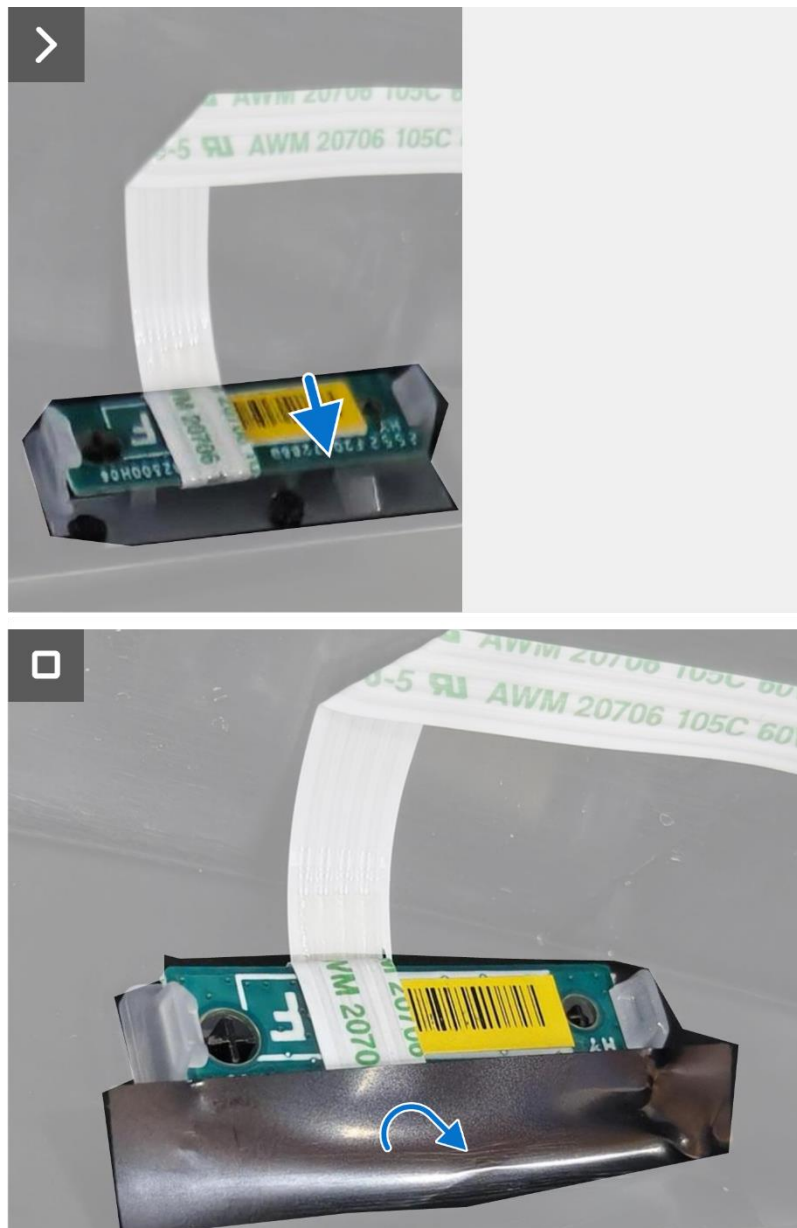
Rysunek 14. Instalacja płyty LED
