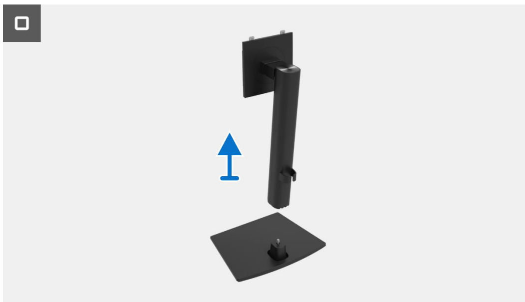
Rysunek 2. Demontaż podstawy
