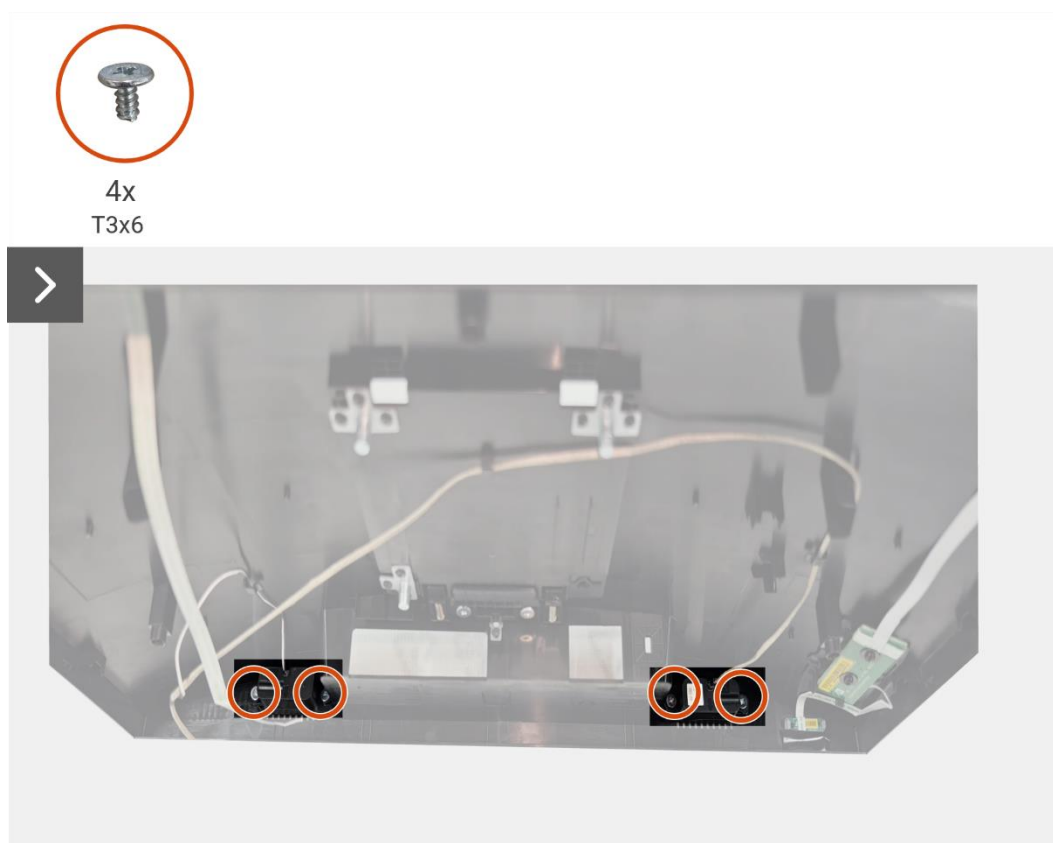
Rysunek 15. Zdejmowanie głośnika
