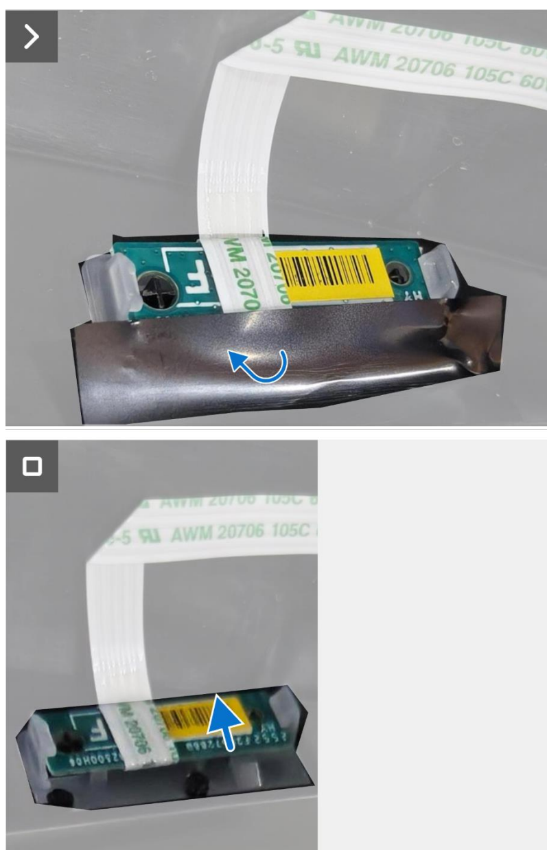
Rysunek 13. Zdejmowanie płyty LED
