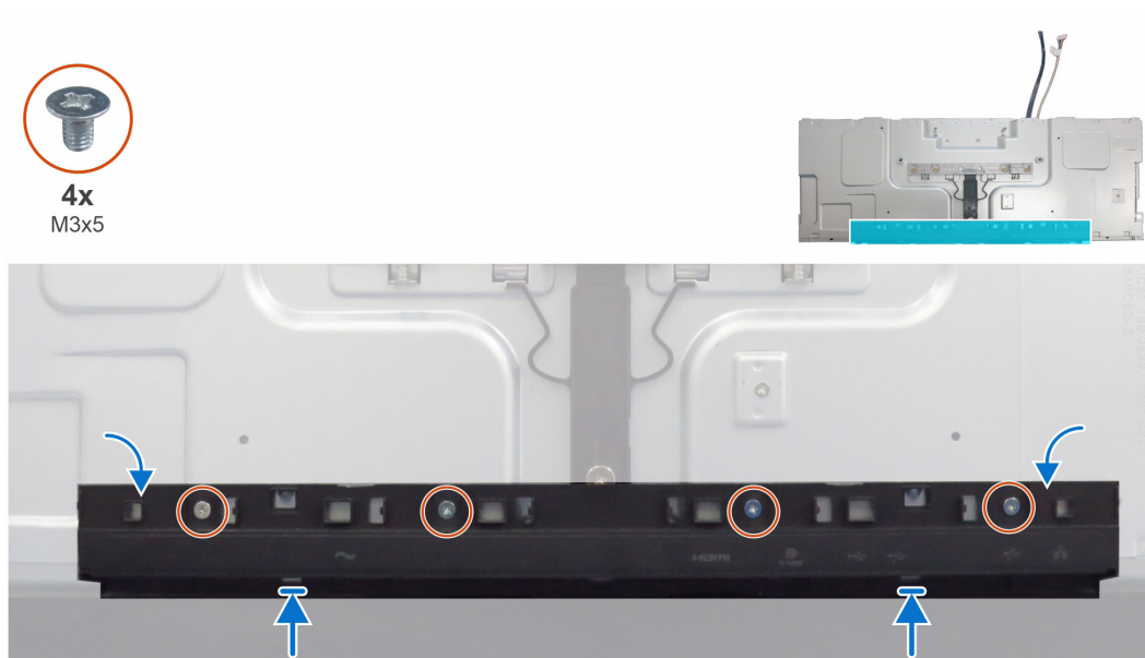
Figure 14. Installation du couvercle d'E/S
