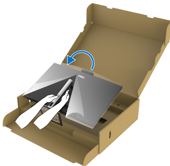
Figur 18. Håll i höjdledsjusteringen och lyft bildskärmen
